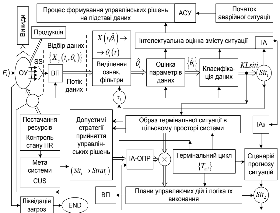
Рис. 12. Інформаційно-логічна модель формування управляючих рішень в умовах виникнення аварійної ситуації в техногенній системі: ОУ — об'єкт управління; ПР — потік ресурсів; \{Sit_i\} — ситуація в системі згідно з даними; ВП — виконавчий пристрій; (ІА-ОПР) — інтелектуальний агент, що приймає рішення; ІА 0 — інтелектуальний агент оперативного рівня; (\tau_i) — інтервал автоматичної обробки сигналів і даних (допустимий час)
