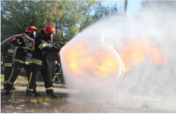
Рисунок 6 – Приклад тактичного використання стволів-розпилювачів для гасіння факельного горіння
