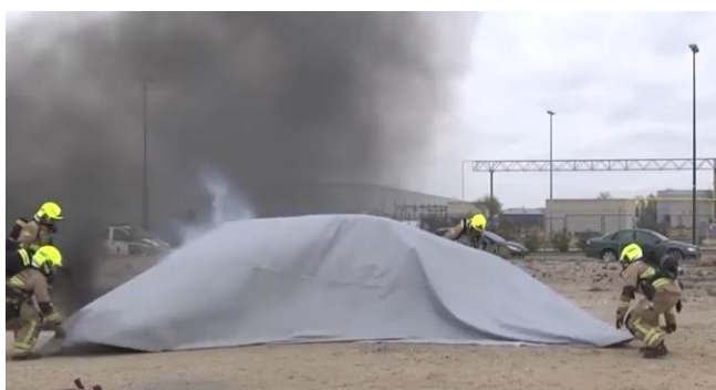
Рисунок 5 – Приклад використання вогнетривкої кошми для гасіння автомобіля
