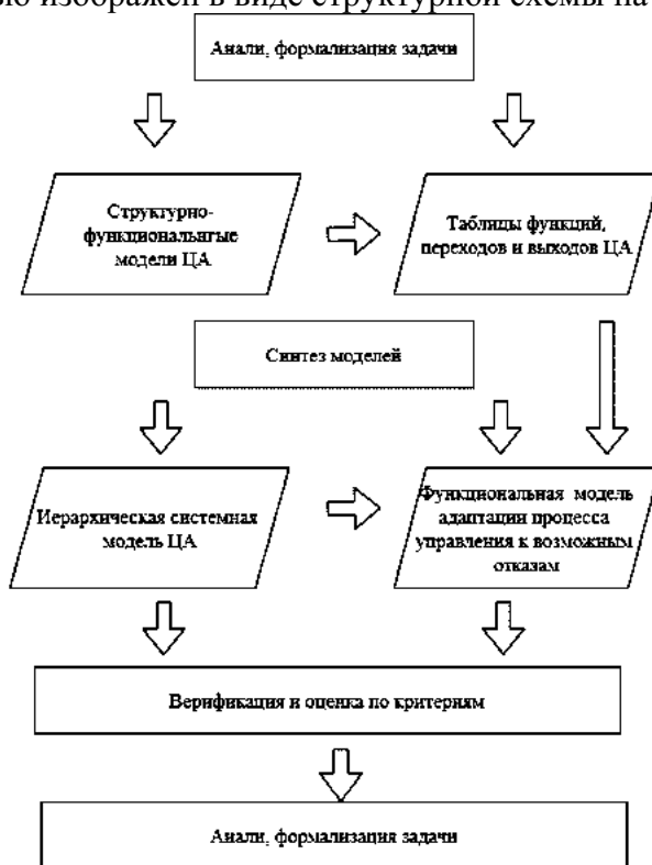
Рисунок 2 – Алгоритм построения структурно-функциональной модели цифровых автоматов АИСОП
