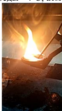
Рисунок 1 – Горение отработанного масла на площадях 23,75 см 2 (лабораторные исследования) и 2641 см 2 (полевые исследования) соответственно
