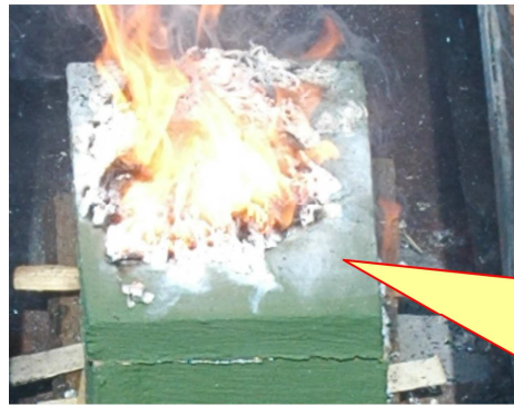
Рис. 4. Результати випробувань модельного зразка обробленого вогнезахисним покриттям на неорганічній основі
