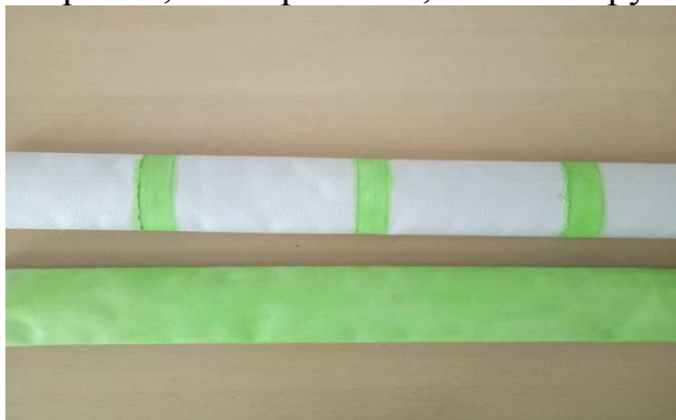
Рис. 1. Зовнішній вигляд зразків фрагмента рукава після нанесення на їх поверхню світловипромінюючої фарби
