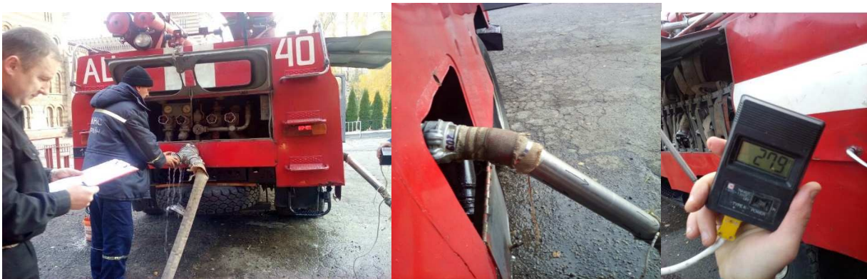
Рис. 3. Проведення експериментального дослідження нагріву води
