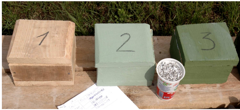
Рис. 1. Модельні зразки дерев'яних конструкцій: 1 – необроблений, 2 – оброблений вогнезахисним покриттям на органо-мінеральній основі; 3 – оброблений вогнезахисним покриттям на неорганічній основі
