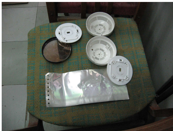
Рис. 1. Вид подготовленной поверхности дымового пожарного извещателя ИП 212-02М1 перед нанесением покрытия
