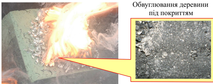
Рис. 3. Результати випробувань модельного зразка обробленого органо-мінеральним захисним покриттям
