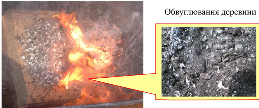
Рис. 2. Результати випробувань необробленого модельного зразка
