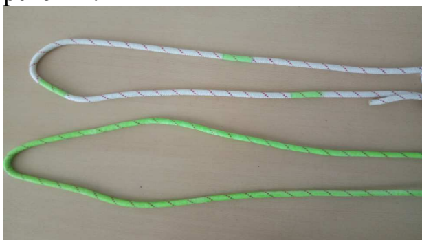
Рис. 3. Зовнішній вигляд зразків фрагмента мотузки після нанесення на їх поверхню світловипромінюючої фарби
