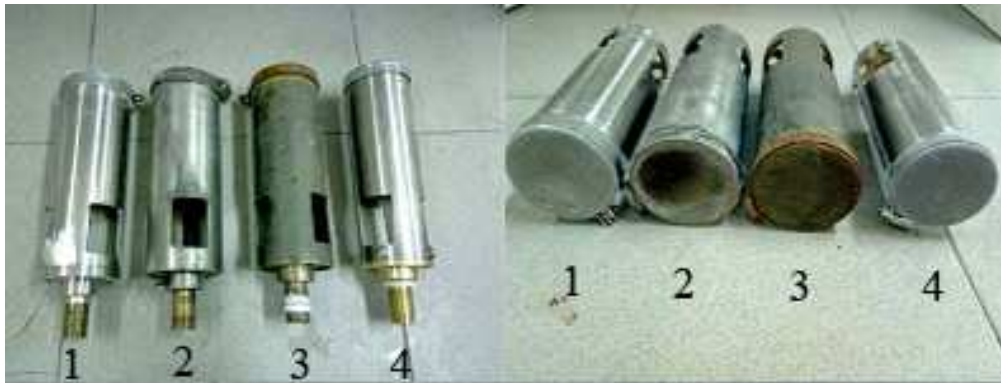
1 – піногенератор наданий ДВЛ ГУ ДСНС України в Миколаївській області (№ 1); 2 – піногенератор НДЦ “ПОЖЕЖНА БЕЗПЕКА” (№ 2); 3, 4 – піногенератори надані ДВЛ ГУ ДСНС України в Одеській області (№ 3 та № 4) Рис. 1. Зовнішній вигляд лабораторних піногенераторів, що застосовувались у ході досліджень
