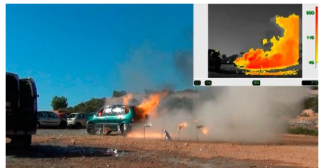
Рисунок 3 – Приклад горіння водню в АВП та його зображення на моніторі пожежного тепловізора
