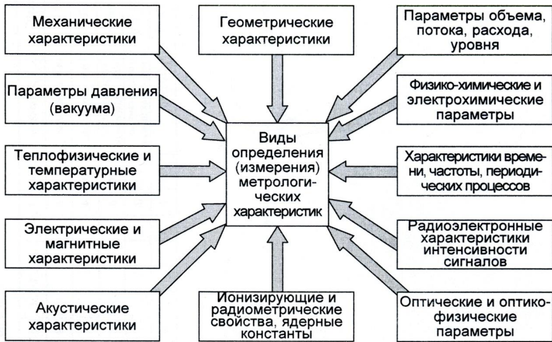
Рисунок 1. Виды определения (измерения) метрологических характеристик композитных конструкций агрегатов ВС ТК
