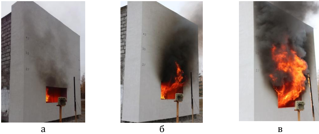
Рисунок 1 – Висота полум'я, яке виходить з віконного отвору під час внутрішньої пожежі, на моменти часу від початку пожежі: а – 1 хв; б – 10 хв; в – 25 хв
