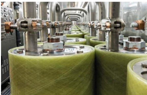
Рис.1 - Мембранний модуль RocheM Spacer Tube
