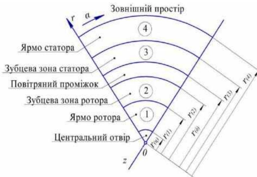
Рис. Семишарова область розрахунку електромагнітного поля асинхронної машини із зубчатим феромагнітним ротором однієї полюсної поділки.
