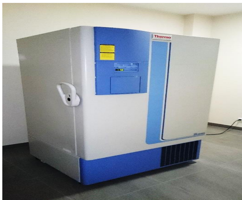
Рис. 3. Морозильна камера «Thermo» з джерелом безперебійного живлення, яка забезпечує температуру – 70^{\circ} С.
