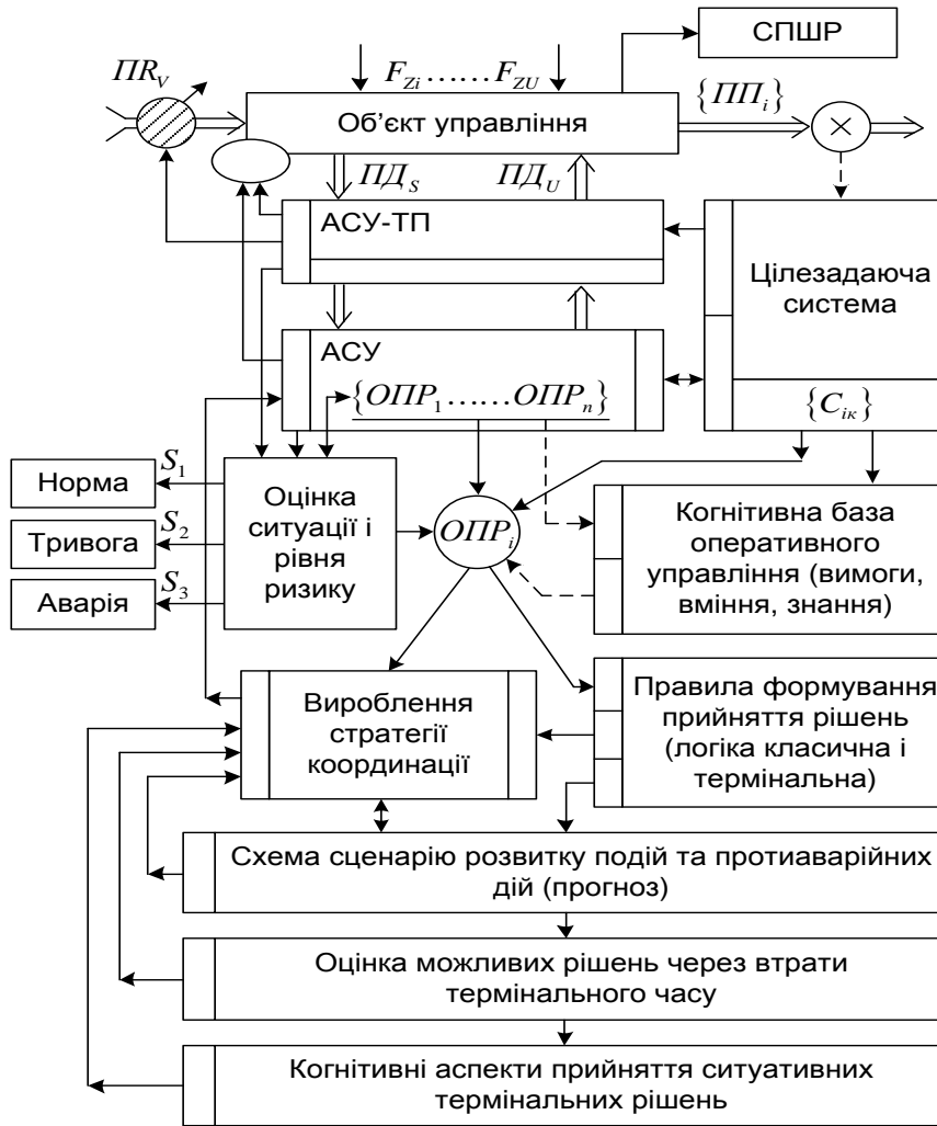
Рис. 4.17. Інформаційна технологія формування темпоральних антикризових рішень: \{PR_v\} — потоки вхідних ресурсів; \{ПП_i\} — потоки продукції; СПШР — складування шкідливих речовин; \{F_{zi}\} — фактори зовнішніх збурень в об'єктах; ПД_s — потоки ситуаційних даних; ПД_u — потоки управляючих даних; \{ОПР_{i=1,n}\} — команда оперативного управління виробництвом
