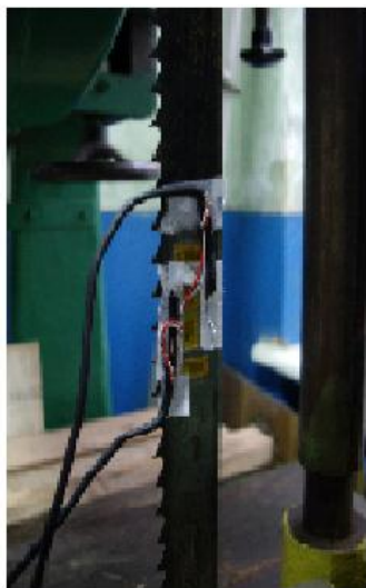
Рисунок 20 – Розташунок тензорезисторів на полотні стрічкової пилки
