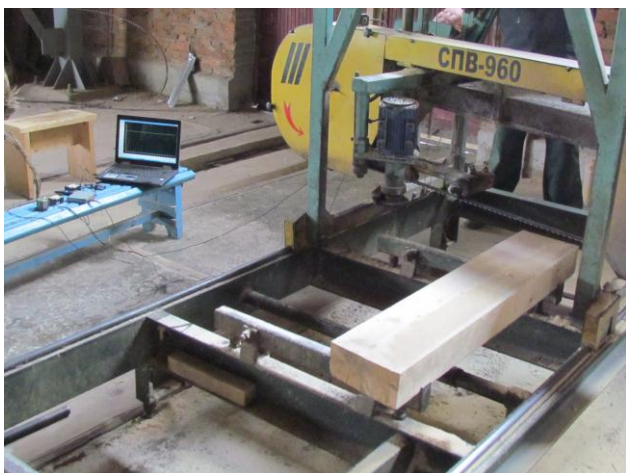
Рисунок 24 – Горизонтальний стрічковопилковий верстат з пристроєм і вимірювальною апаратурою
