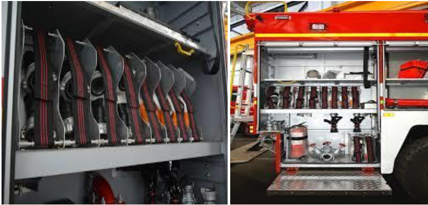
Рисунок 1 - Пожежні напірні рукава (з права – загальний вид, з ліва – детальний «збільшений» вид) у відсіку автоцистерни.
