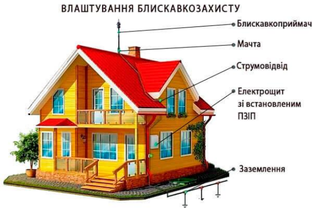
Рисунок 1 - Влаштування блискавкозахисту. Основні елементи
