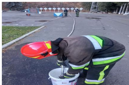
Рисунок 2 - визначенням об'єму рукава діаметром 38 мм
