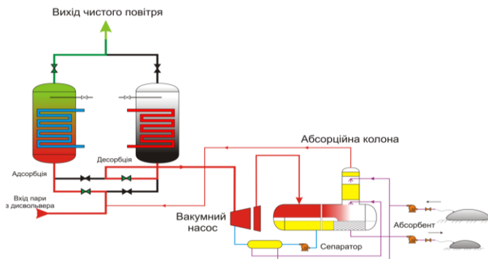
Рисунок 1 - Схема абсорбційної установки вловлювання і рекуператії пари спирту.
