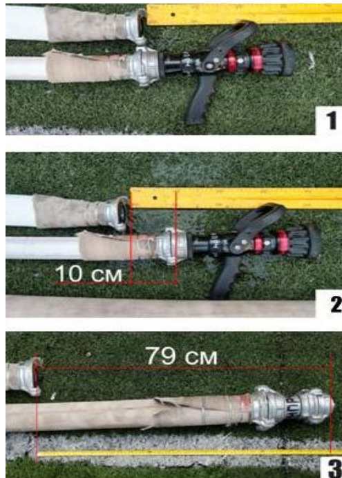
Рисунок 1 - Вимірювання зміни довжини досліджуваних пожежних рукавів
