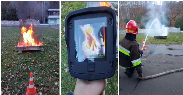
Фото 2 - Фіксування моменту досягнення температури макетного вогнища більше 450 °С і його гасіння
