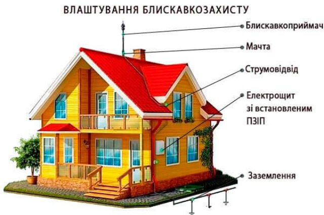
Рисунок 1 - Влаштування блискавкозахисту. Основні елементи
