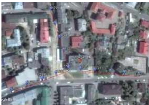
Рисунок.1. – Приклад вибору точок замірів навколо БС із вимірними результатами.
