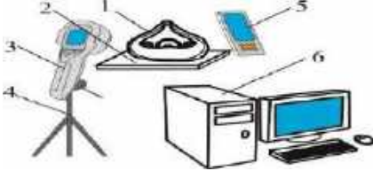
Рисунок 1. – Загальний вигляд стенду для визначення щільності прилягання півмаски до обличчя: 1- респіратор; 2 робоча платформа з фіксаторами; 3 тепловізор; 4 штатив з регулятором висоти; 5 далекомір; 6 – персональний комп'ютер
