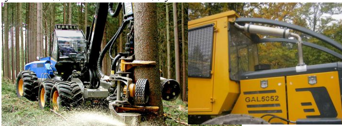
Рисунок 2. а – підготовка харвестером зрізаного стовбура до падіння, б – захисні дуги кабіни трельовального трактора GAL українського виробництва.
