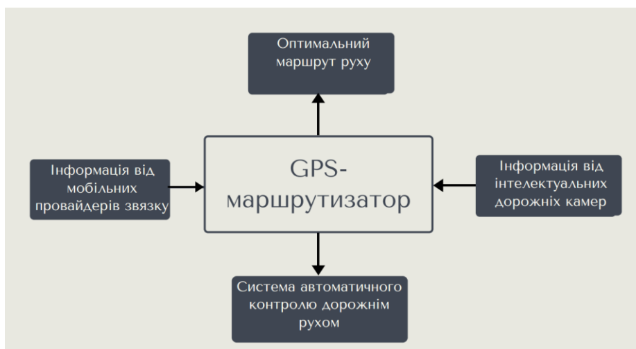
Рис. 3. Принципова схема роботи GPS-маршрутизатора.
