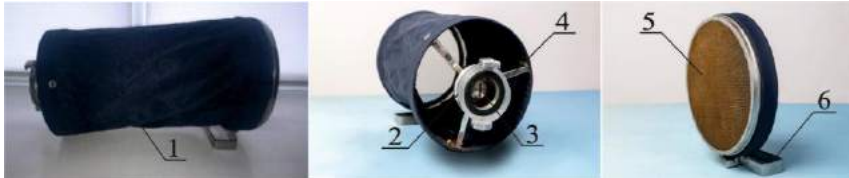
Рисунок 1 – Будова ППГ. 1 - гнучкий циліндричний корпус; 2 – з'єднувальна головка; 3 – розпилювач; 4 – опорна вставка; 5 – набір латунних сіток; 6 – ручка для утримування.
