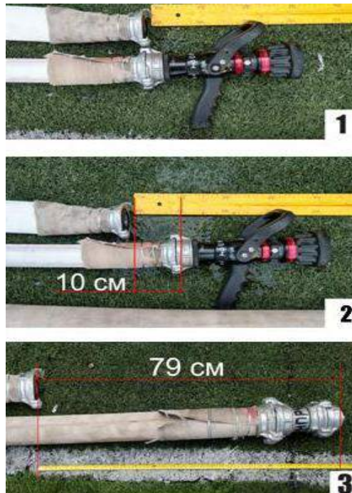
Рисунок 1 - Вимірювання зміни довжини досліджуваних пожежних рукавів
