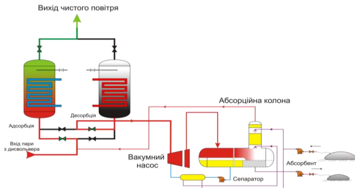
Рисунок 1 - Схема абсорбційної установки вловлювання і рекуперації пари спирту.
