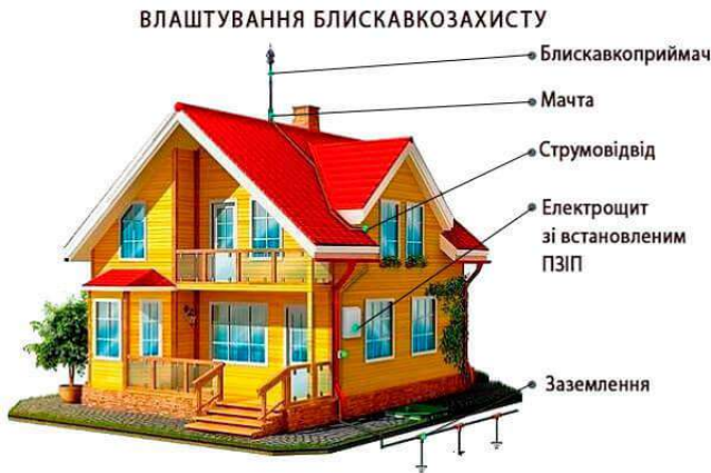
Рисунок 1 - Влаштування блискавкозахисту. Основні елементи
