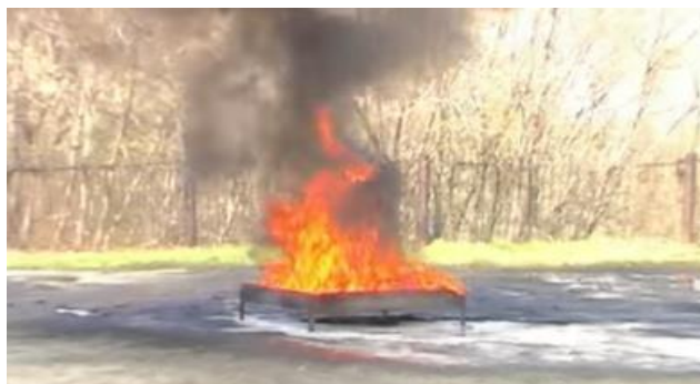
Рисунок 13 – Експериментальна посудина із дизельним паливом
