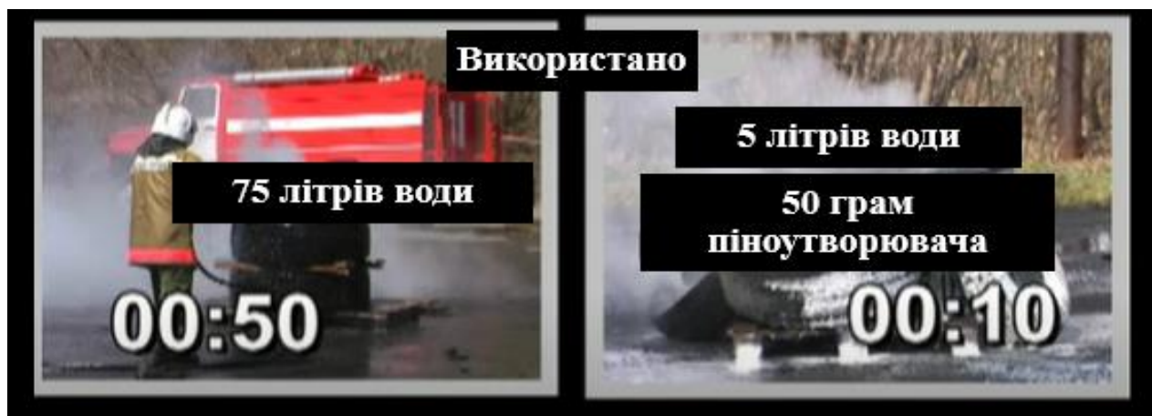
Рисунок 12 – Витрати вогнегасних речовин на гасіння автомобільних шин
