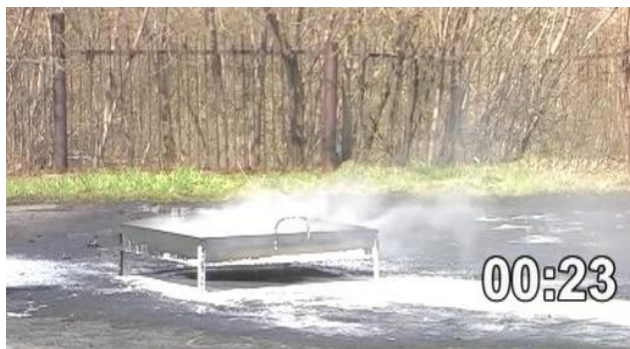
Рисунок 14 – Результат гасіння посудини із дизельним паливом за допомогою компресійної піни
