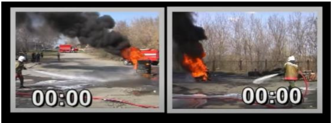
Рисунок 10 – Підготовка автомобільних шин для гасіння за допомогою води (ліворуч) та компресійної піни (праворуч)
