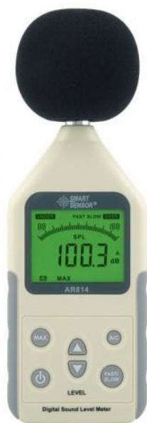
Рис. 2.- Цифровий шумомір AR814, що використовувався у процесі дослідження рівнів акустичних характеристик у Шацькому НПП
