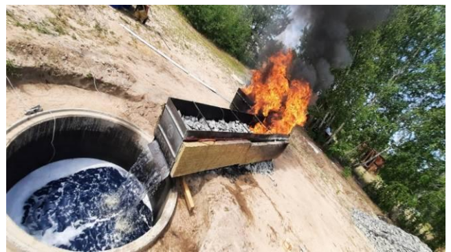
Рисунок 3.10 – Зображення дослідного стенду під час визначення ефективного значення ухилу маслоприймача у бік маслозбірника
