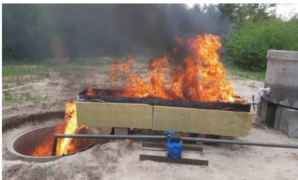
Рисунок 3.10 – Зображення дослідного стенду під час визначення ефективного значення ухилу маслоприймача у бік маслозбірника
