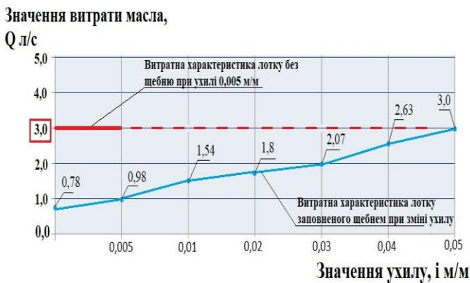
Рисунок 8 – Залежність витрати масла під час проходження гравійною засипкою від ухилу маслоприймача
