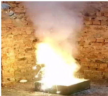
Рисунок 1 – Взаємодія горючого металу з водою
