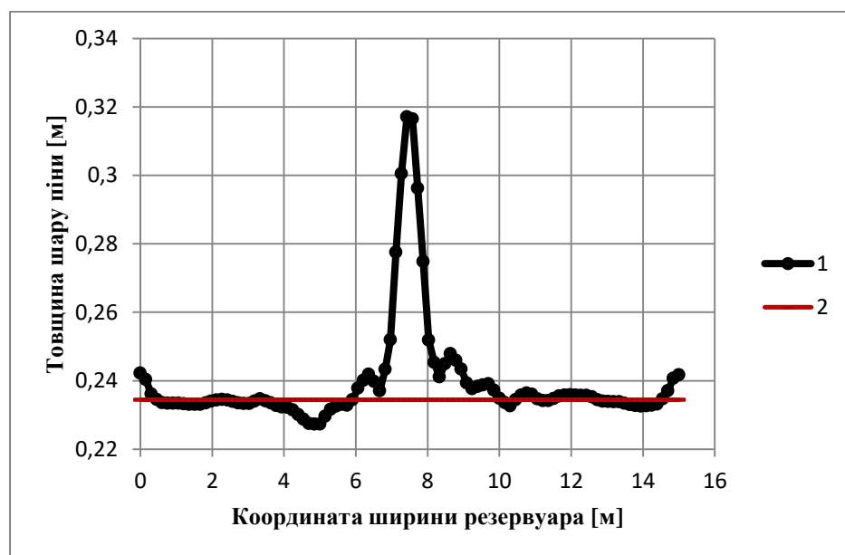
Рис. 2.8. Залежність товщини піни від координати ширини резервуара у випадку одного центрального струменя (1 – значення товщини шару піни; 2 – середнє значення товщини піни на поверхні)
