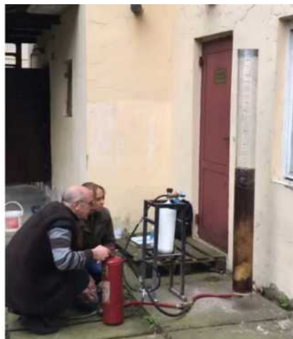
Рис. 3.9. Процес випробування з визначення швидкості підйому піни крізь шар нафтопродукту
