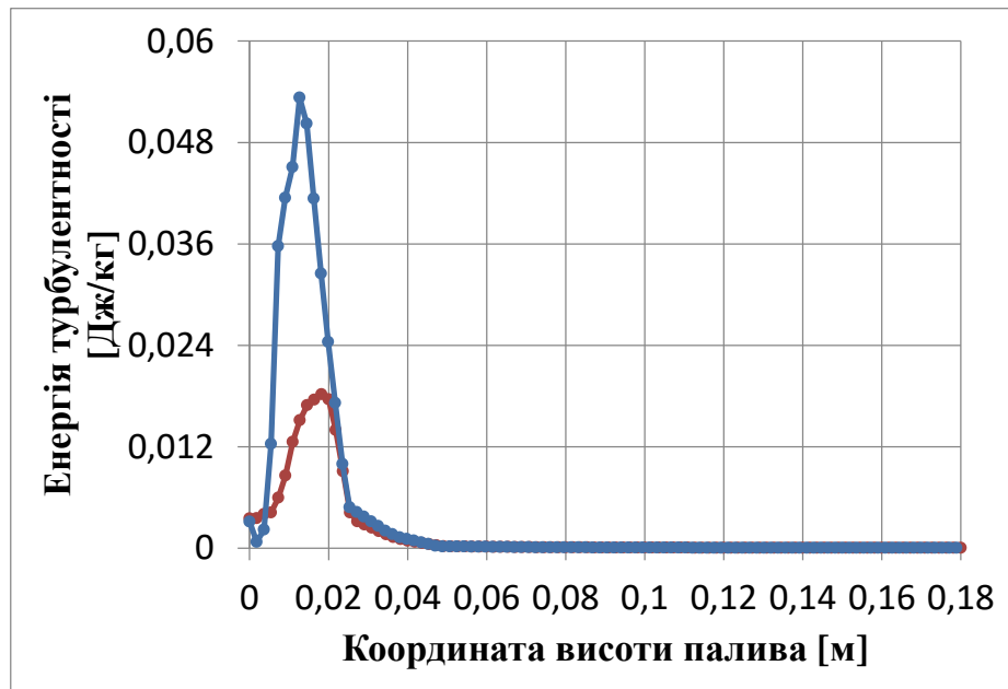
Рис. 2.42. Графічна залежність енергії турбулентності від координати висоти дизельного палива: червона лінія – у центральній частині струменя; синя – зміщення на 60 мм ліворуч до максимального значення
