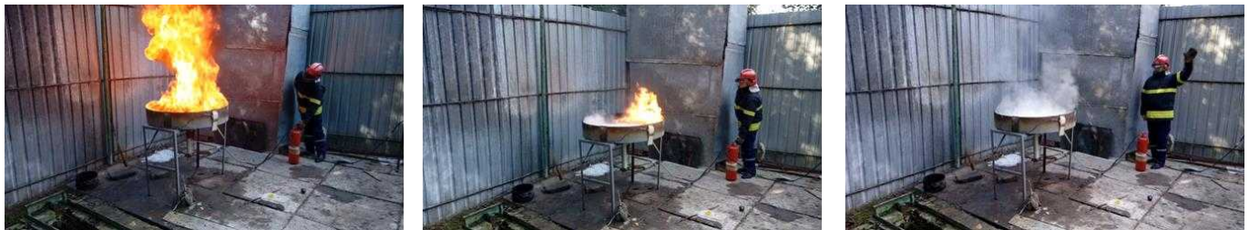
Рис. 3.4. Етапи гасіння бензину на установці УПШГ-1 “підшаровим” способом: а – вільне горіння бензину; б – процес “підшарового” гасіння; в – припинення горіння
