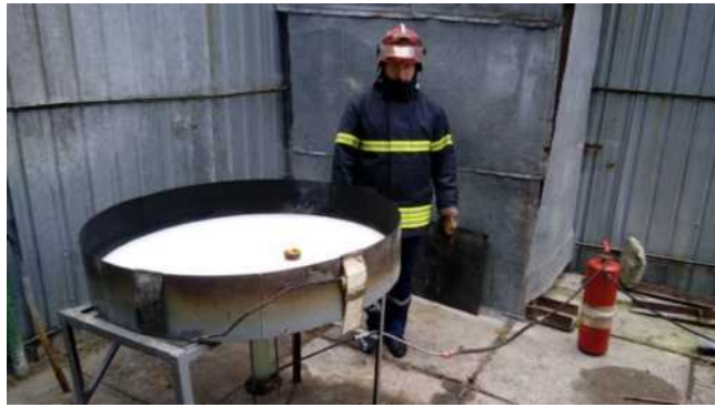
Рис. 3.7. Фрагмент процесу проведення випробування на можливість повторного займання бензину
