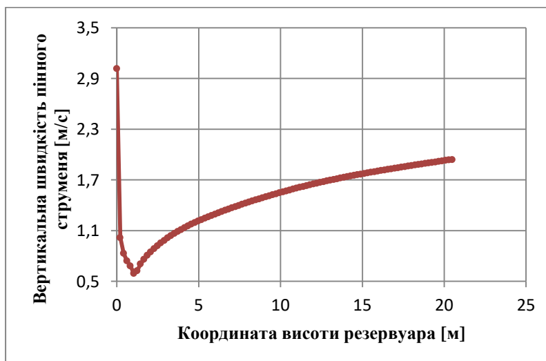
Рис. 2.19. Залежність вертикальної швидкості пінного струменя від координати висоти резервуара
