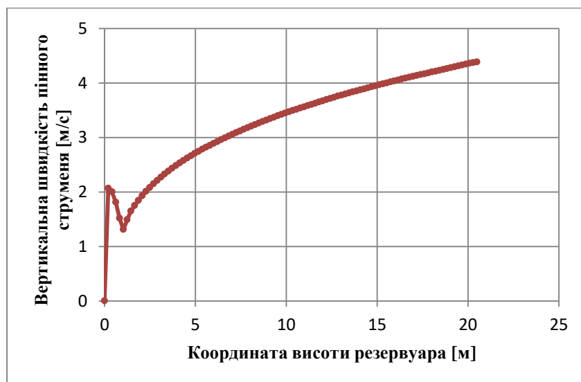
Рис. 2.32. Залежність вертикальної швидкості збірного пінного струменя від координати висоти резервуара
