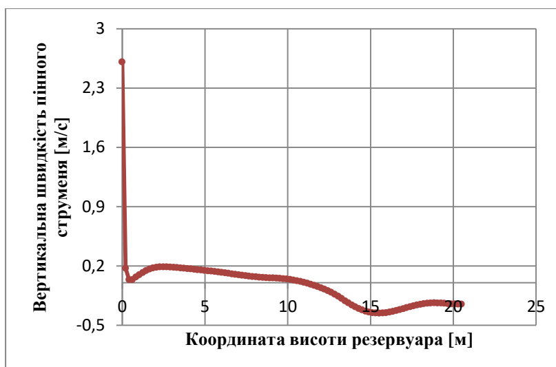
Рис. 2.16. Залежність вертикальної швидкості пінного струменя від координати висоти резервуара
