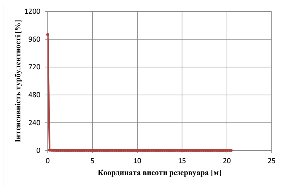
Рис. 2.23. Залежність інтенсивності турбулентності збірного пінного струменя від координати висоти резервуара
