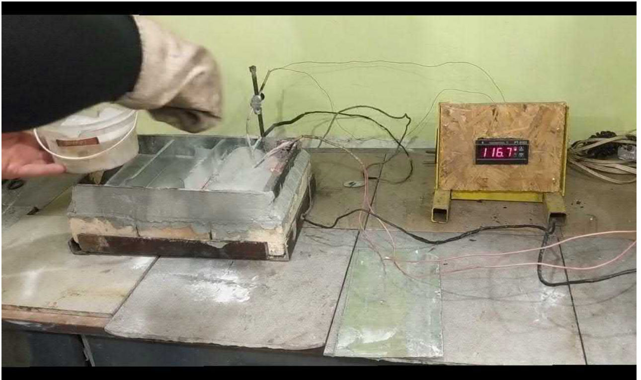
Рисунок 3.2 – Насипання порошку при гасінні сплаву магнію в лабораторних умовах
