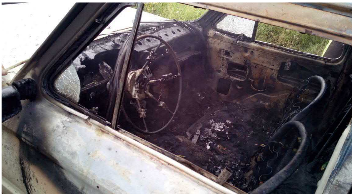
Рисунок 1.3 – Наслідки пожежі в м. Дунаївці спричинені горінням сплаву магнію і алюмінію
