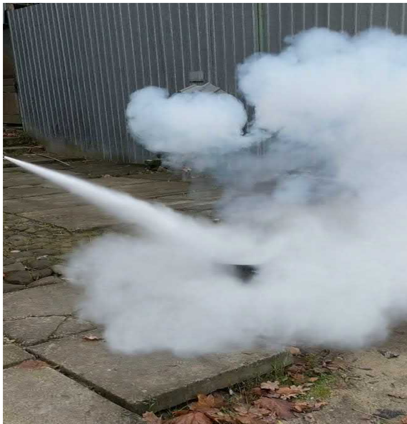
Рисунок 2.3 – Гасіння макетної пожежі класу В вогнегасним порошком КМ-2
