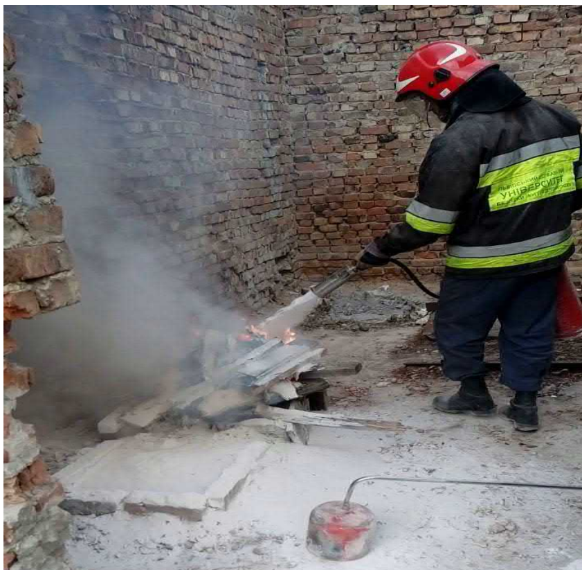
Рисунок 4.10 – Гасіння комбінованої пожежі деревини і магнію після подавання порошку піною підвищеної стійкості
