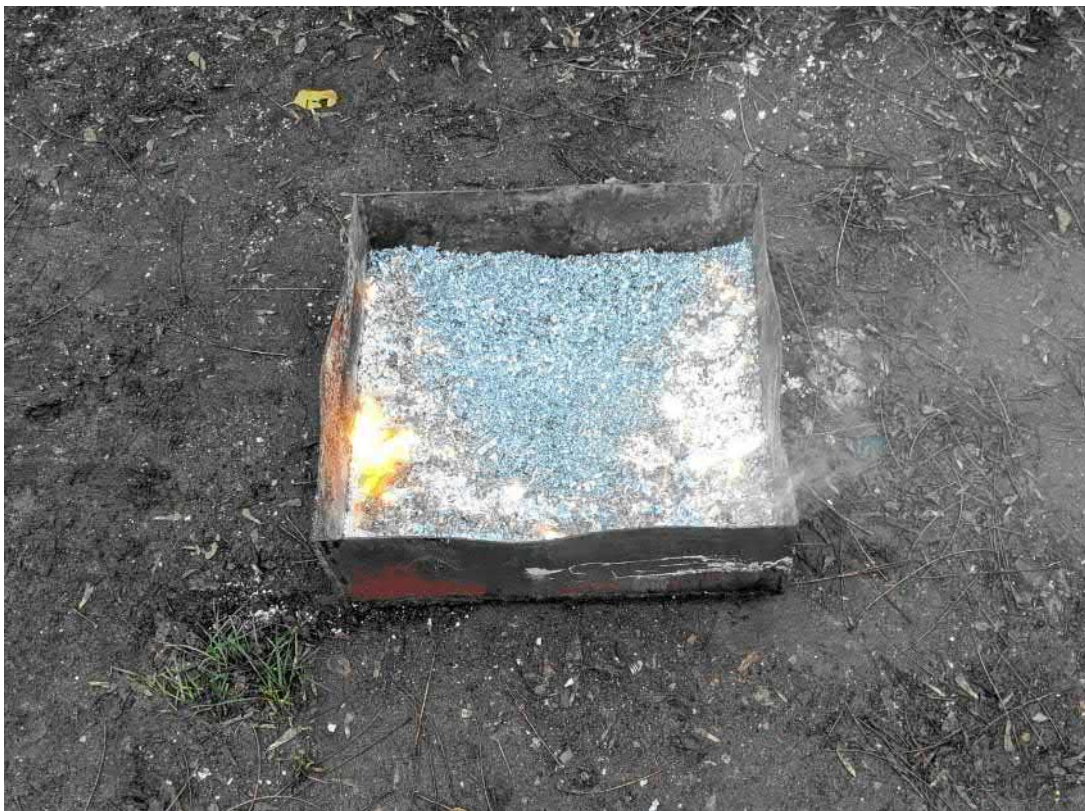
Рисунок 4.5 – Розгорання сплаву магнію в модельному деку
