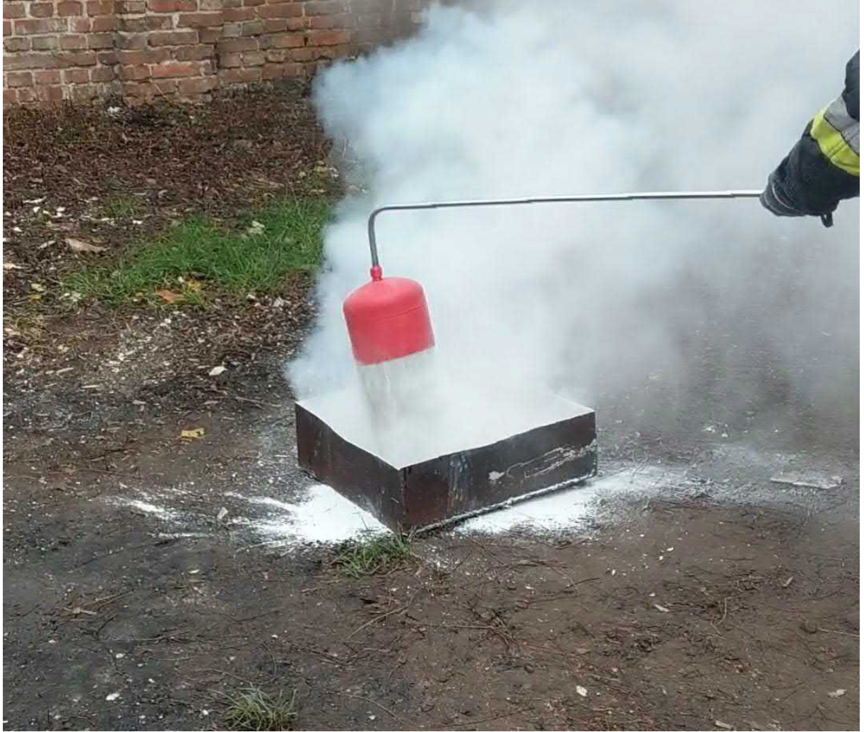
Рис. 4.6 – Гасіння магнію порошком КМ-2 з використанням насадки-заспокоювача
