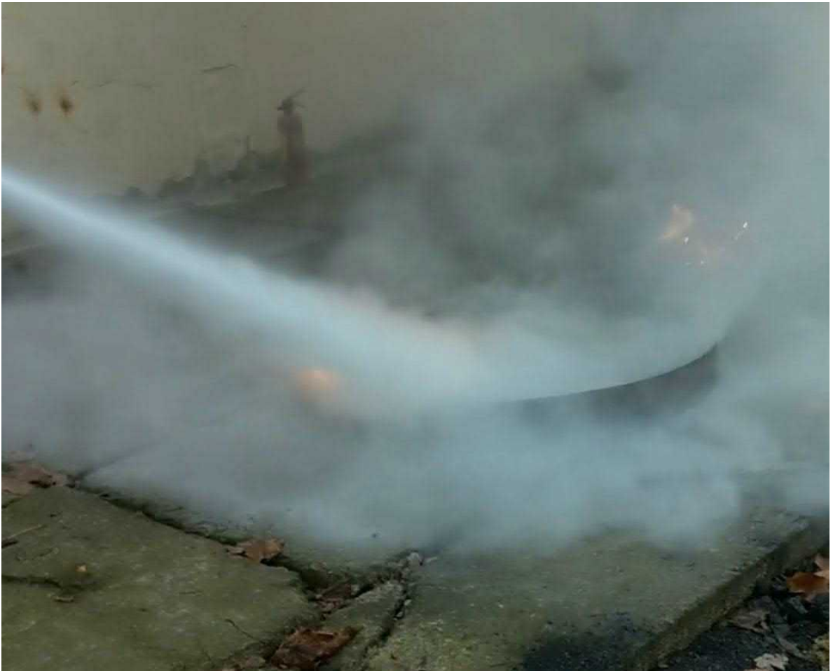
Рисунок 4. 8 – Гасіння модельного вогнища 21В порошком КМ-2
