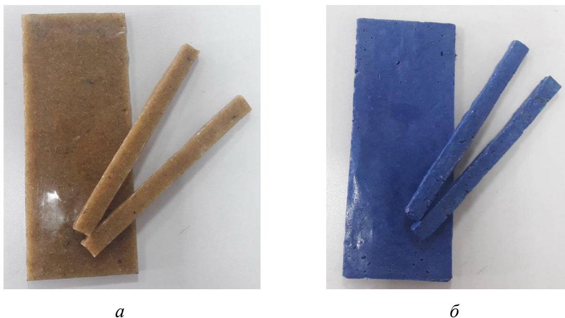
Рисунок 6.3 – Деревинностружкові зразки з використанням епоксидних клейових композицій: a – без антипірену; б – з антипіреном
