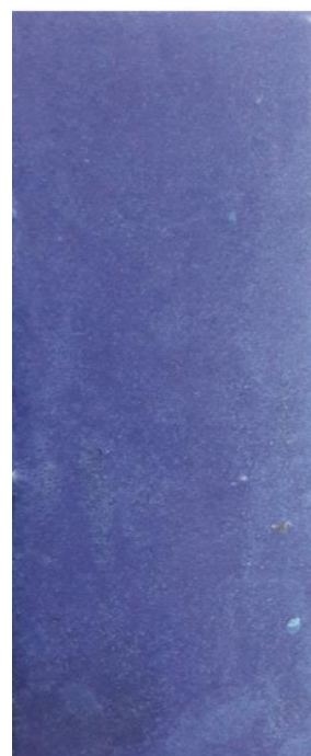
Рисунок Е.12 – \text{CuSiF}_6 -вмісне епоксіамінне композиційне покриття деревини
