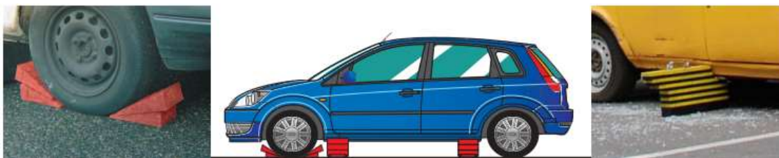
Рис. 1. Приклад стабілізації ТЗ, що стоїть на колесах
