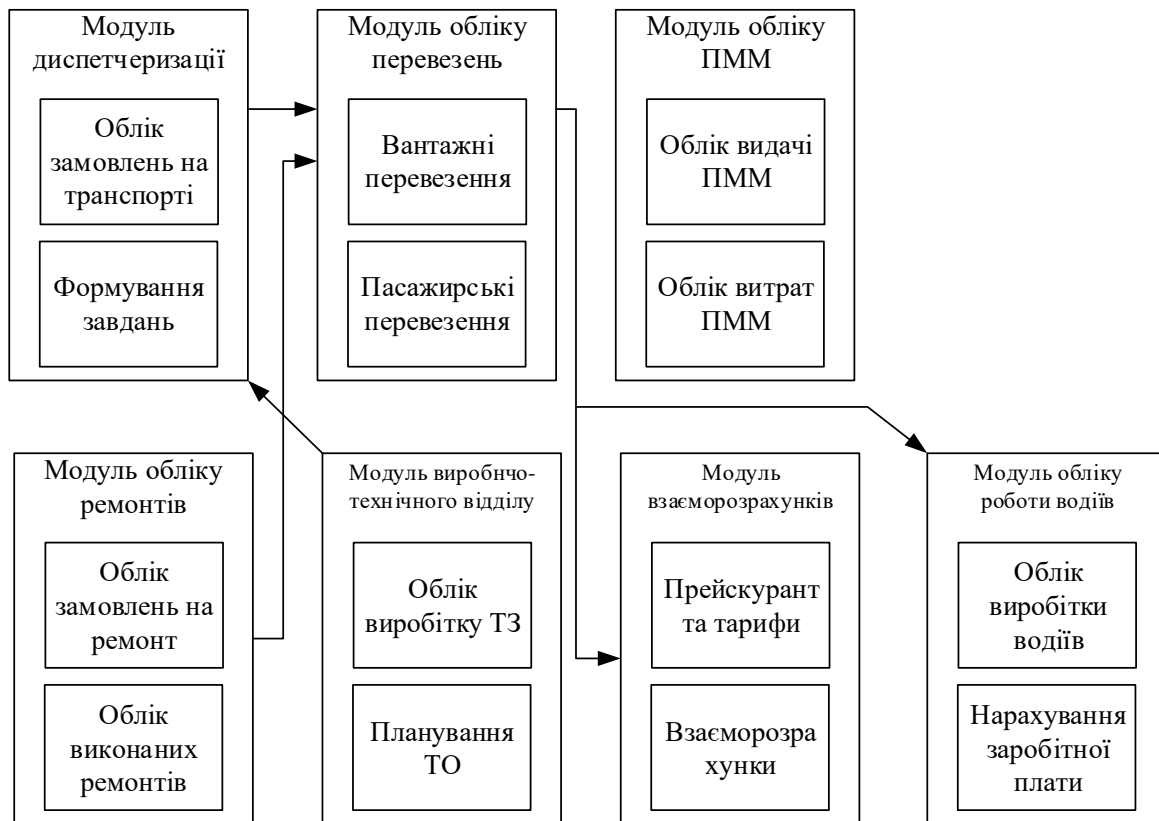
Рис. 4.15. Структурна схема програми для керування автотранспортом
