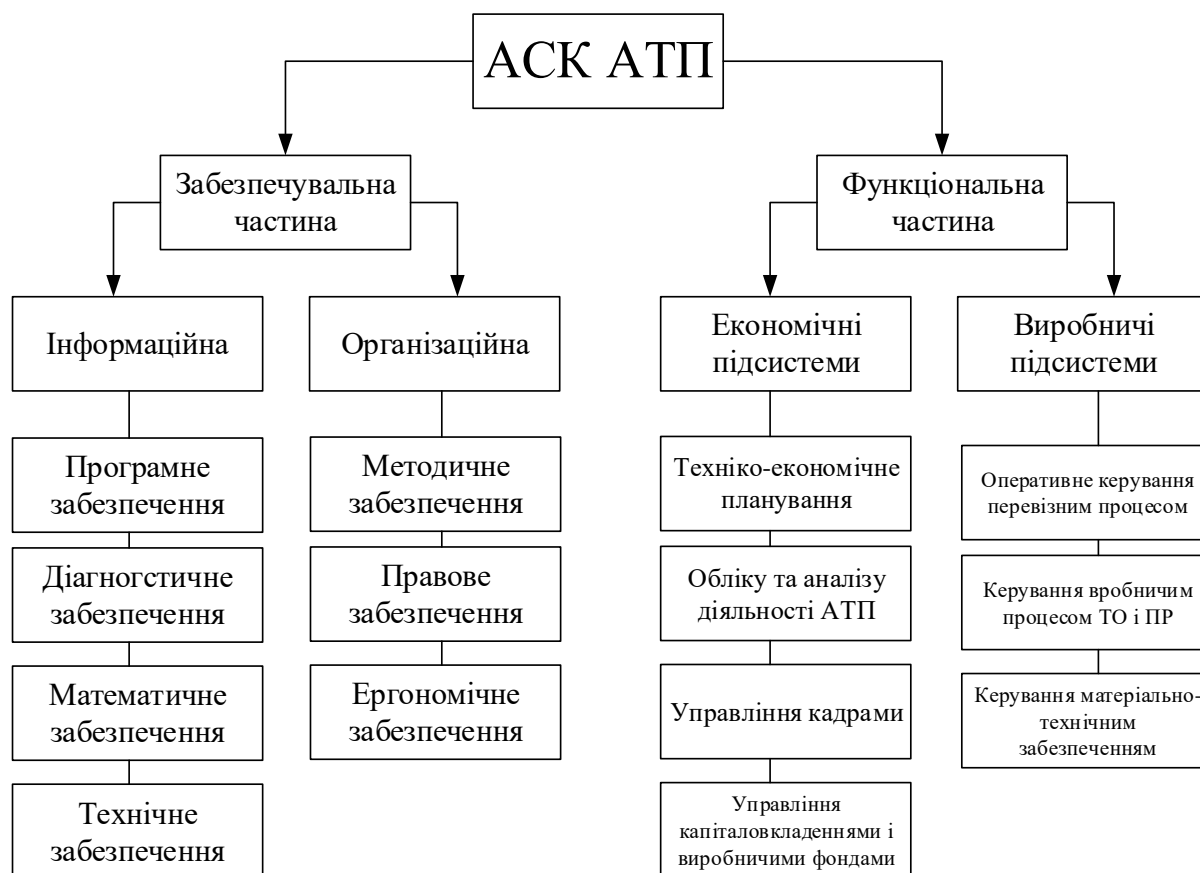
Рис. 4.13. Інтегрована структура автоматизованої системи керування
