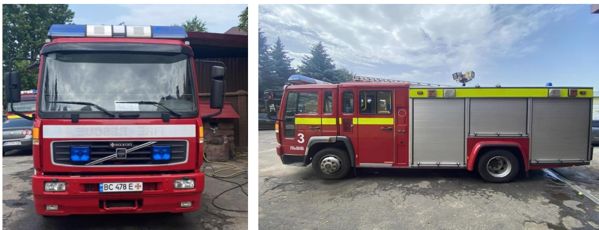
Рис. 4.24. Автоцистерна пожежна АЦ на базі шасі автомобіля Volvo (донор – Велика Британія)
