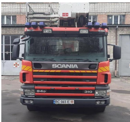
Рис. 4.25. Автопідіймач пожежного типу АД-32 на базі шасі Scania з підіймачем Bronto Skylift F32RL
