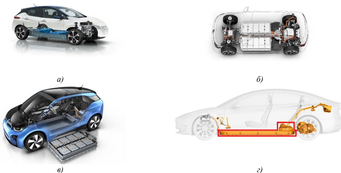
Рисунок 1 – Приклади розміщення акумуляторної літій-іонної батареї в електромобілях провідних виробників світу: а) – Ніссан; б) – Фольцваген; в) – БМВ; г) – Тесла
