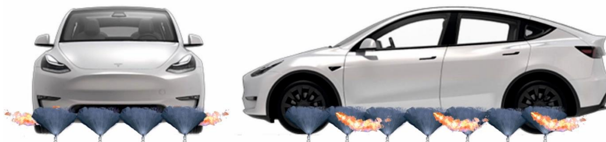
Рисунок 3 – Принципова схема розміщення дренчерної установки пожежогасіння на паркувальному місці електромобіля
