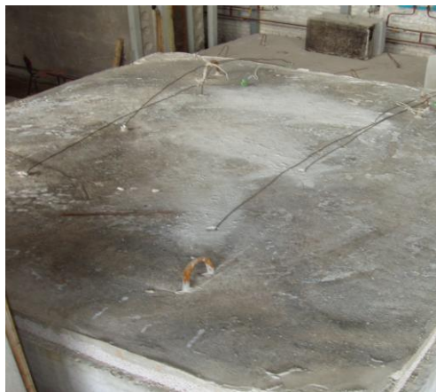
Рис. 3.11. Вигляд сталезалізобетонної плити-зразку для випробувань
