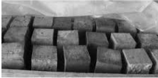
Рис. 4.2. Вигляд бетонних кубічних зразків для випробувань на міцність.
