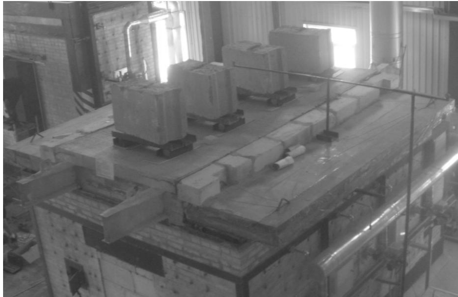
Рис. 3.2. Зовнішній вигляд зразка конструкції, що встановлений на горизонтальній випробувальній установці.
