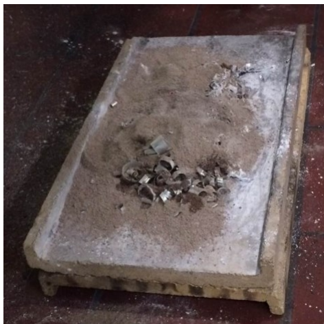
Рисунок 2 – Результати випробувань вогнегасних порошоків для гасіння магнію
