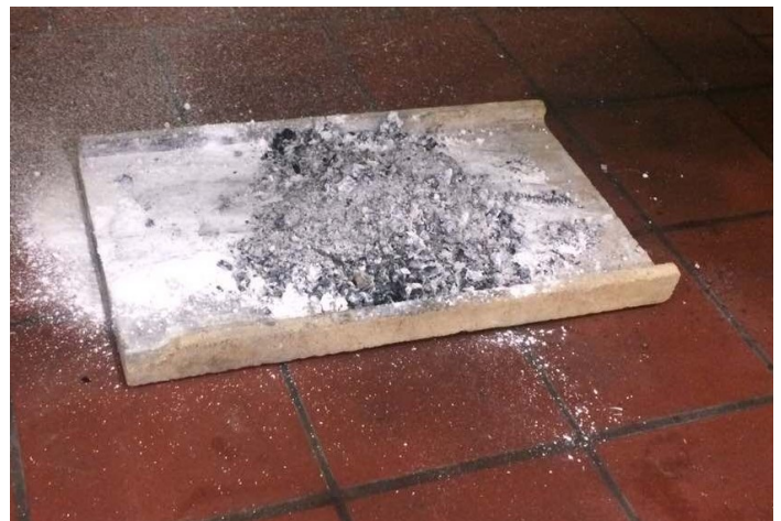
Рисунок 2 – Результати випробувань вогнегасних порошоків для гасіння магнію
