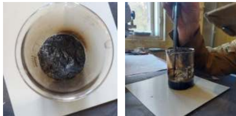
Рисунок 1 – Зразки спученого покриття після проведення випробувань
