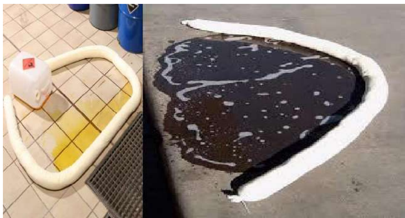
Рис. 3.14. Створення перешкод на шляху розтікання НХР
