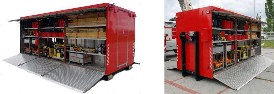
Рис. 4.4. Модуль для виконання робіт з пошуку та рятування людей в зруйнованих будівлях
