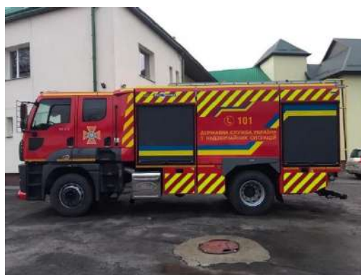
Рис. 4.21. Автоцистерна пожежна АЦ-5,0-50 (1833) – 442F
