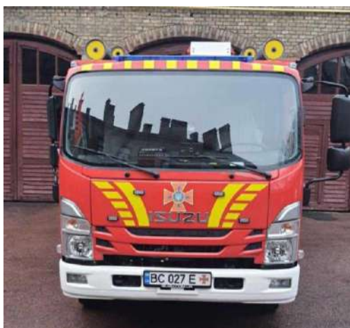
Рис. 4.22. Автоцистерна пожежна АЦ-2,5-30 (NQR90)-537IS
