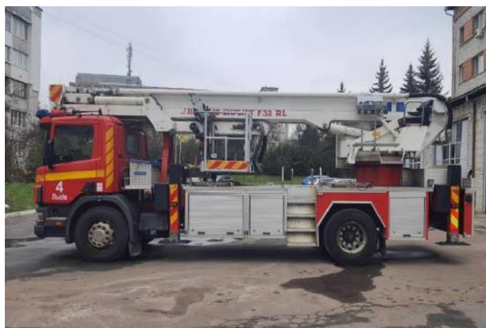
Рис. 4.25. Автопідіймач пожежного типу АД-32 на базі шасі Scania з підіймачем Bronto Skylift F32RL
