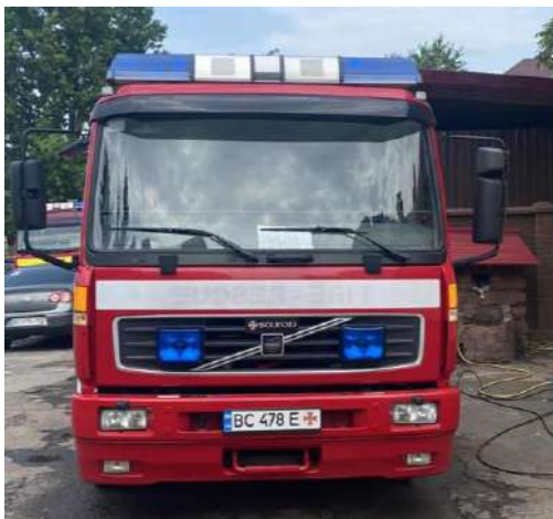
Рис. 4.24. Автоцистерна пожежна АЦ на базі шасі автомобіля Volvo (донор – Велика Британія)
