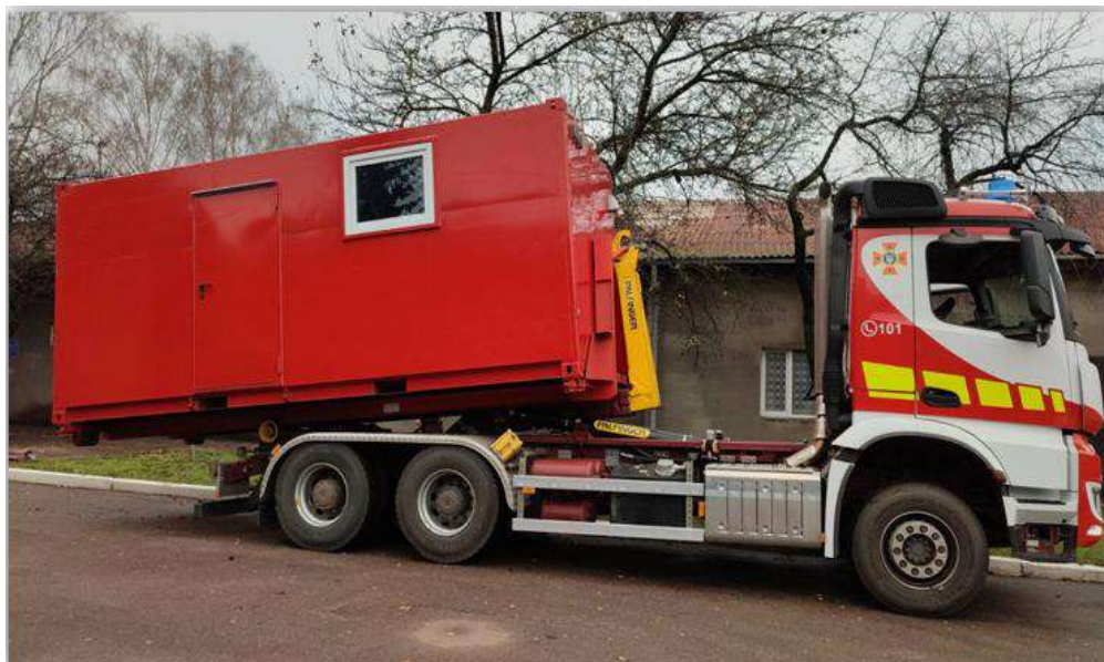
Рис. 8.76. Мобільний тренажер контейнерного типу
