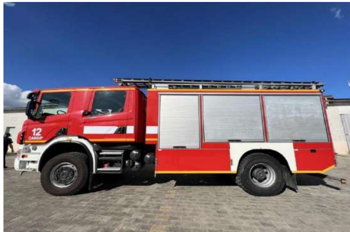
Рис. 4.23. Автоцистерна пожежна АЦ на базі шасі автомобіля Scania (донор – Польща)
