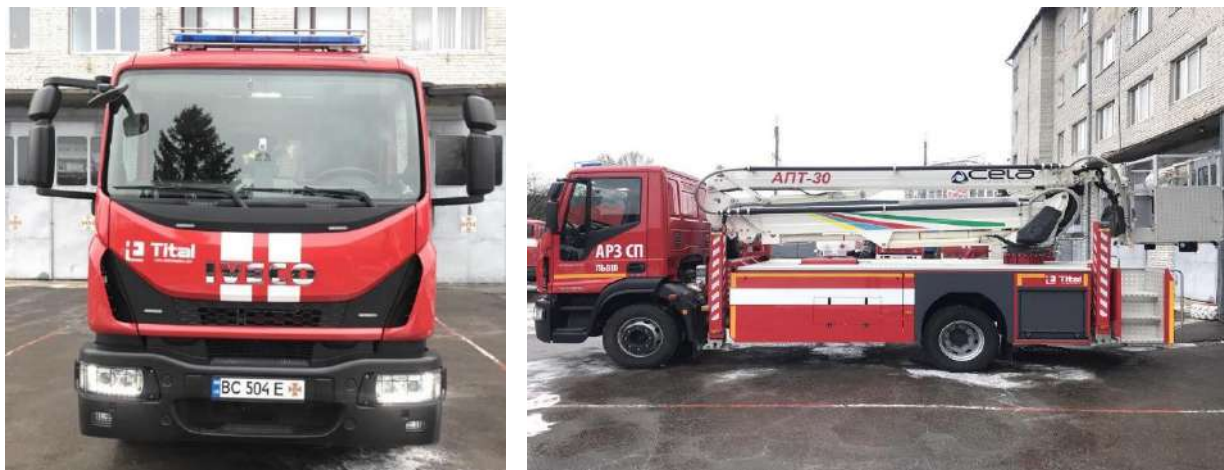
Рис. 4.26. Автопідіймач пожежного типу АПТК-30 (ML150E25)
