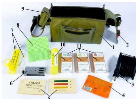
Рис. 3.19. Загальний вигляд військового комплексу хімічної розвідки ORM-17:
