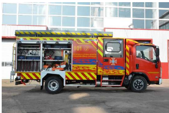
Рис. 4.22. Автоцистерна пожежна АЦ-2,5-30 (NQR90)-537IS
