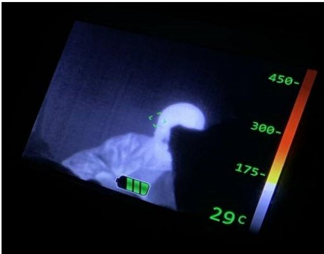
Рисунок 2 – Виявлення потерпілого в задимленому приміщенні за допомогою пожежного тепловізора
