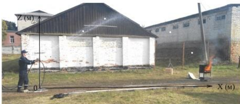
Рисунок 2 – Формування експериментальних даних для аналітичної побудови траєкторій руху струменів, що подаються з установки
