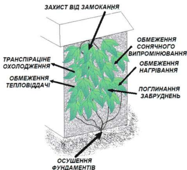
Рис. 7 – Вплив ліан роду Parthenocissus Planch. на фасад будинку [8]
