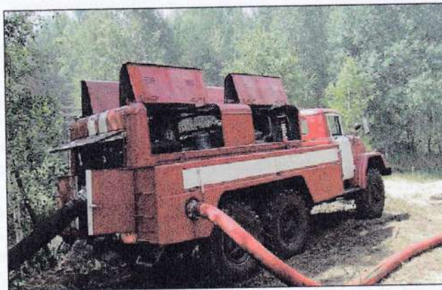
Рис. 14 – Використання пожежної насосної станції ПНС-110 (131) 131А з метою перекачування води в цілях пожежогасіння [12]
