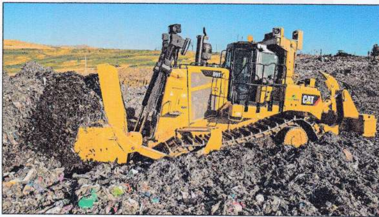
Рис. 5 – Загальний вигляд бульдозера Caterpillar Cat D9T під час роботи на полігоні ТПВ [8]
