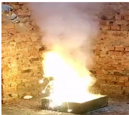
Рисунок 1 – Взаємодія горючого металу з водою
