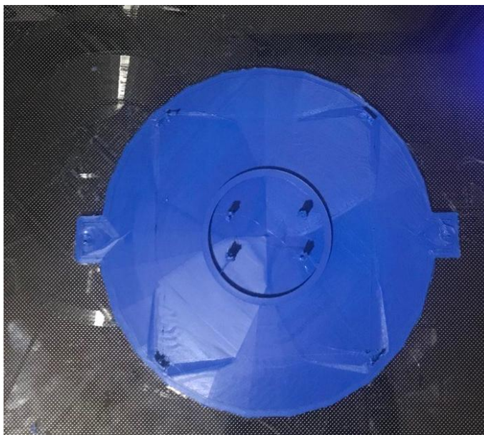
Рис. 3. Результат 3D -друку нижньої кришки корпусу ПС з новими елементами кріплення.
