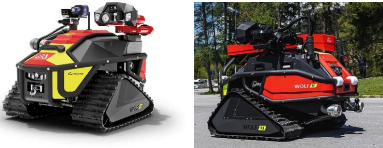
Рисунок 1 – Тактичний робот Magirus WOLF R1
