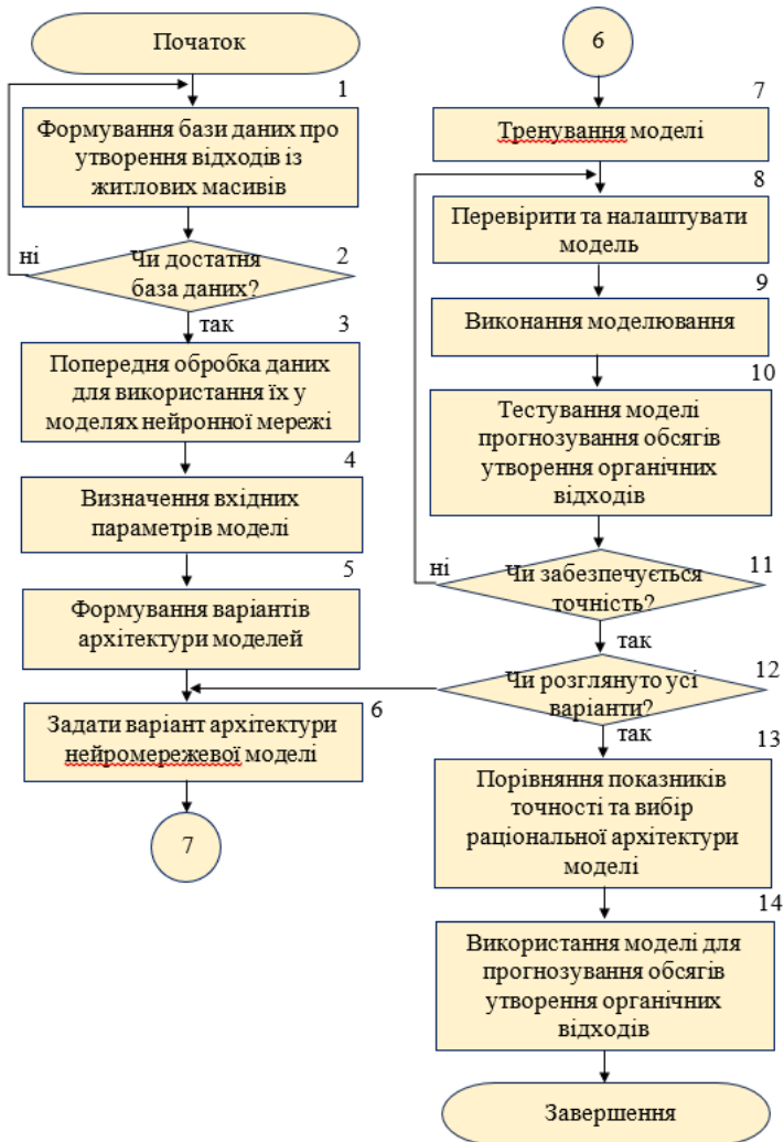
Рисунок 1 – Алгоритм прогнозування обсягів утворення органічних відходів домогосподарствами у проектах виробництва екологічно чистої енергії
