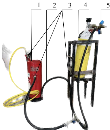
Рисунок 1 – Лабораторна установка типу вогнегасника для генерації компресійної піни: 1 – корпус вогнегасника (ємність для змішування води та ПУ); 2 – з’єднувальні шланги; 3 – запірні вентиля; 4 – балон із стиснутим повітрям; 5 – редуктор із манометром.
