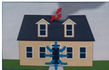
Рисунок 2 – Приклад проведення вертикальної вентиляції
