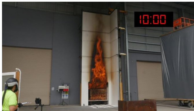
Рисунок 1.27 – Фото вогневих випробувань за DIN 4102-20
