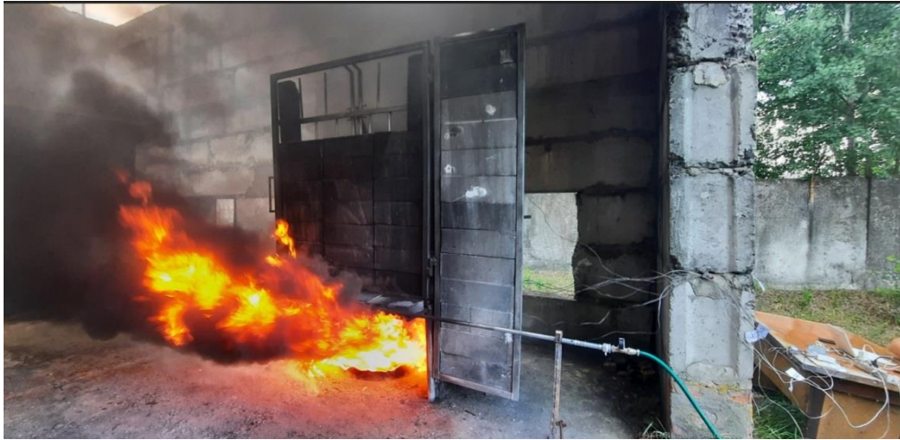
Рисунок 5.9 – Експериментальні дослідження процесів обмеження поширення пожежі по зовнішнім огорожувальним конструкціям фасадною протипожежною перешкодою активного типу
