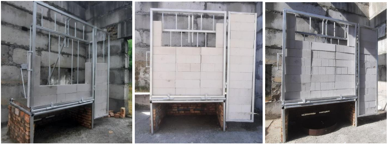
Рисунок 4.16 – Рівнішній вигляд варіантів виконання міжповерхових віконних простінків з різною висотою
