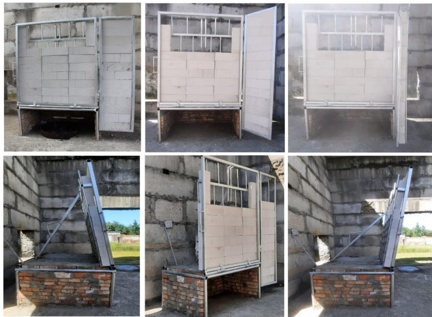
Рисунок 4.20 - Загальний вигляд виготовленої установки та її конструктивні можливості трансформації
