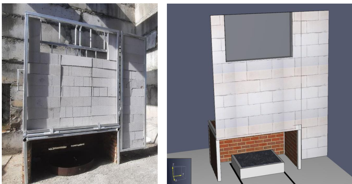
Рисунок 6.1 - Зовнішній вигляд натурної експериментальної установки та її відтвореної FDS моделі
