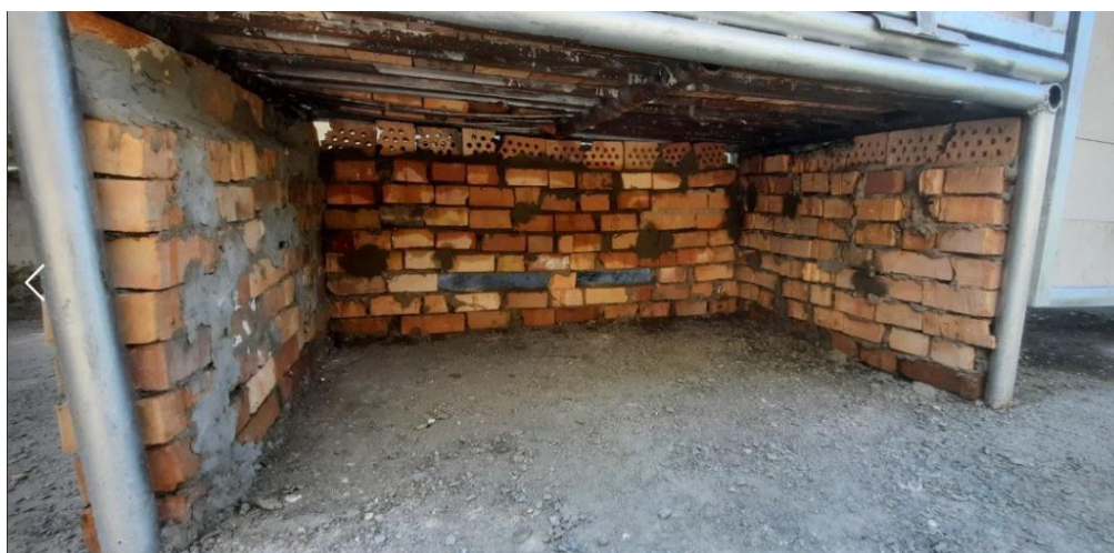
Рисунок 4.15 – Зовнішній вигляд вогневої камери Випробувальної установки
