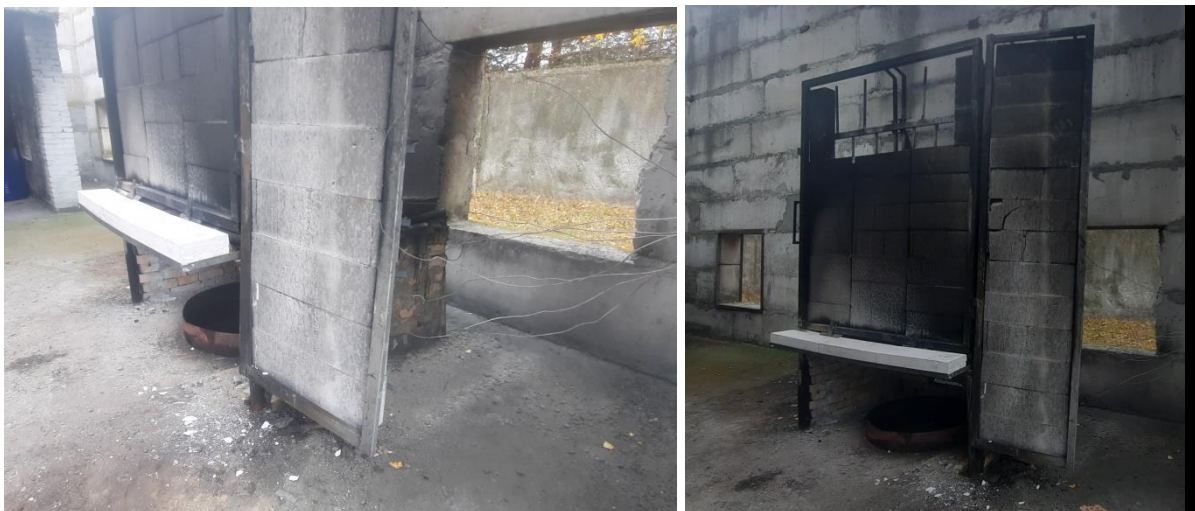
Рисунок 5.5 – Зовнішній вигляд установки обладнаної фасадною протипожежною перешкодою пасивного типу (протипожежним карнизом)
