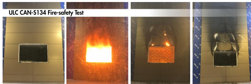
Рисунок 1.25 – Фрагмент випробувань фасадних систем щодо пожежної безпеки за методом CAN/ULC S-134
