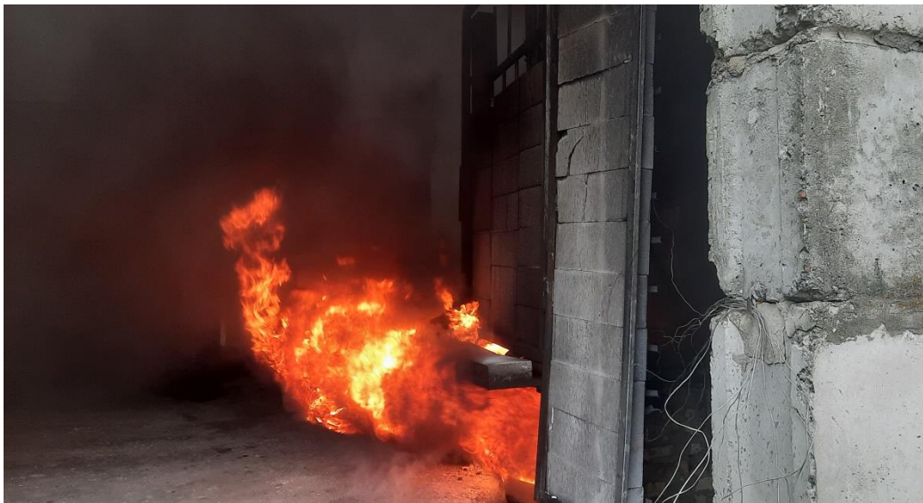
Рисунок 5.6 – фото натурних вогневих досліджень впливу протипожежного карнизу на процеси обмеження поширення пожежі по фасаду
