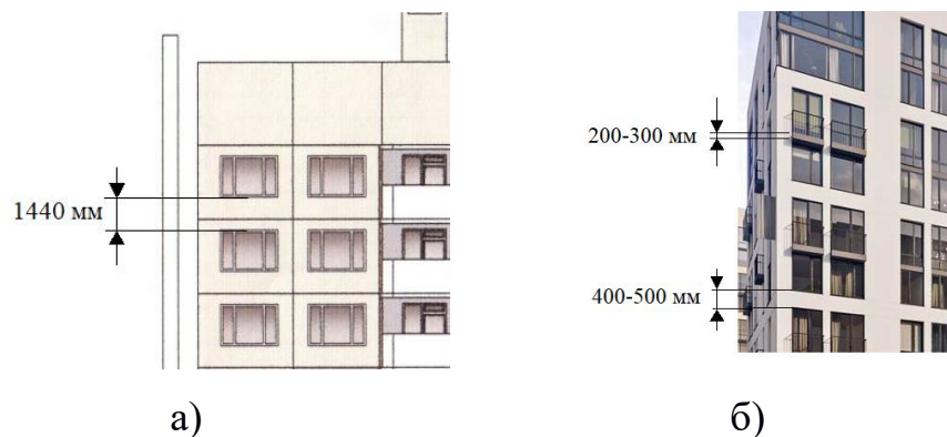
Рисунок 4.2 – Схематичні приклади поверхових міжповерхових віконних простінків, де: а – максимальне значення висоти простінку, б – мінімальні значення висоти простінку виконаного для світлопрозорих фасадних систем
