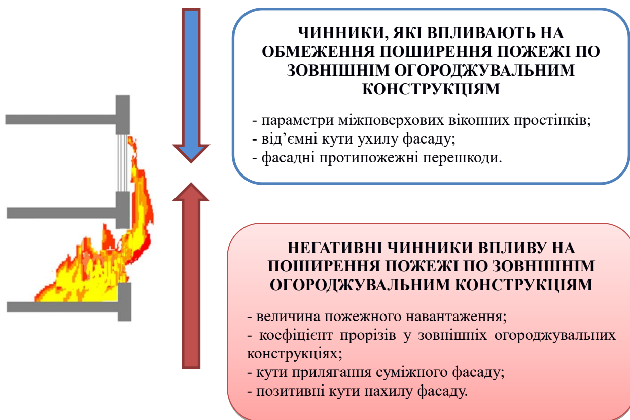
Рисунок 7.1 – Узагальнення основних чинників, що впливають на процеси поширення пожежі по фасаду будівлі або на процеси запобігання її впливу
