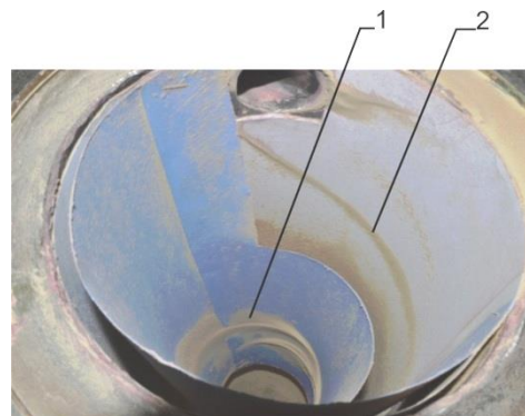
Рис.3. Виды треков в полости циклона при экспериментальных исследованиях (скорость пылегазового потока на входе в циклон u_{вх}=12 м/с, концентрация пыли c_{вх}=16 г/м 2 , дисперсность частиц \bar{d}_m=25 мкм, \sigma=54 ): а - вид треков внутри циклона при следующих параметрах пылегазового потока; б - вид треков в экспериментальном циклоне с конической вставкой: 1 – жгут на внутренней поверхности конусной вставки – «малый жгут»; 2 – жгут на внутренней поверхности корпуса – «большой жгут».
