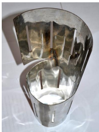
Рис.1 Модель конической вставки в циклон
