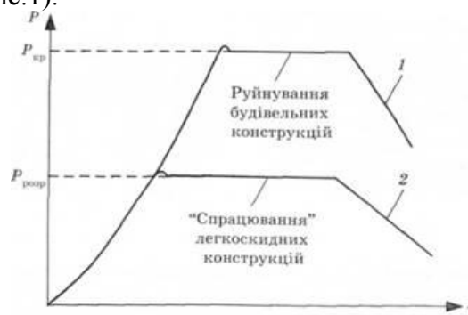
Рис. 1. Графік зміни тиску в приміщенні у разі вибуху: 1 – у приміщенні без легкоскидних конструкцій; 2 – у приміщенні з легкоскидними конструкціями
