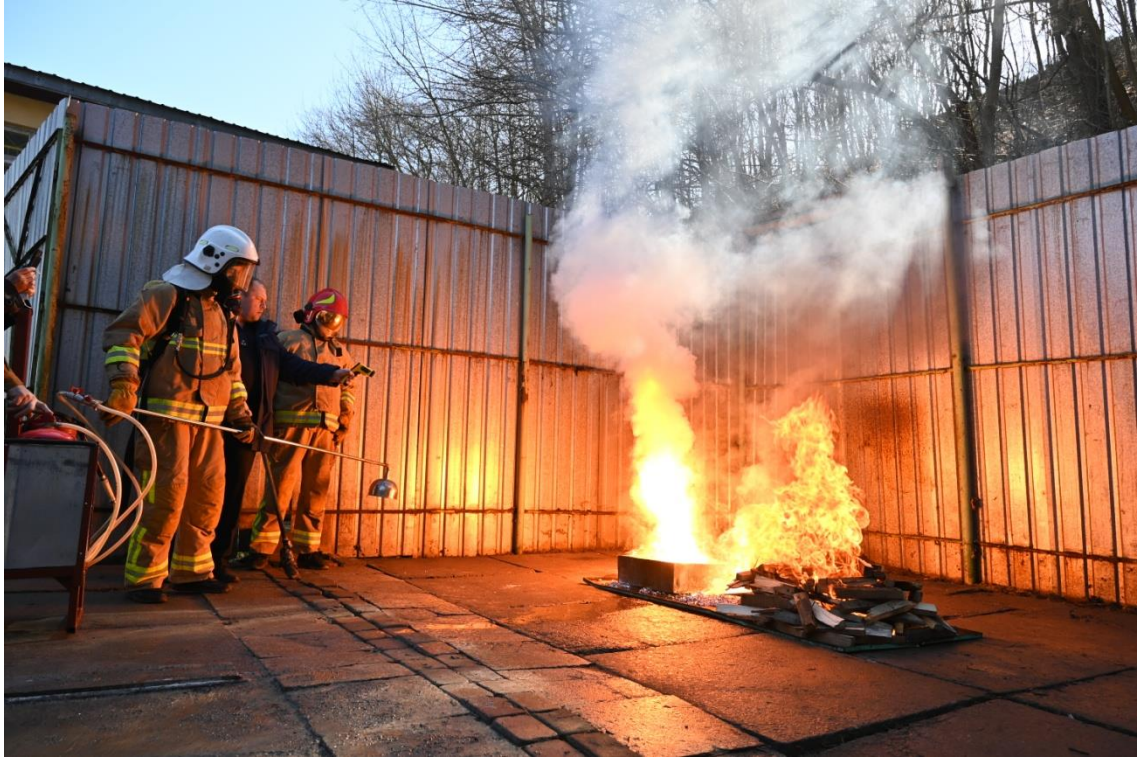
Рис. 4.5. Комбінована пожежа магнію, деревини і нафтопродукту
