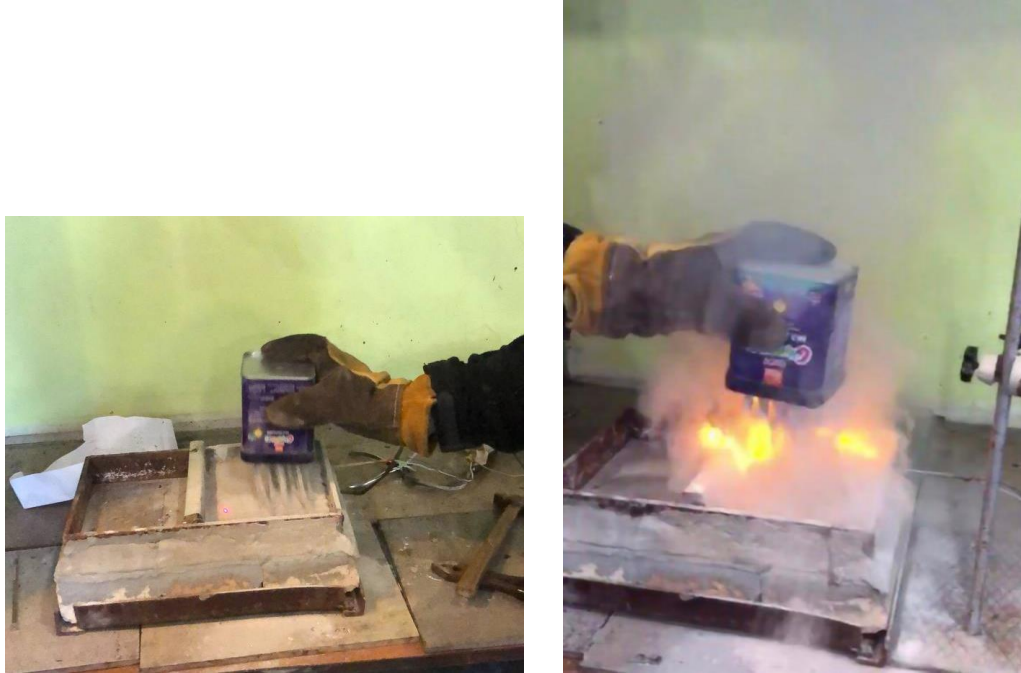
Рис. 2.7. Насипання порошку при гасінні сплаву магнію в лабораторних умовах
