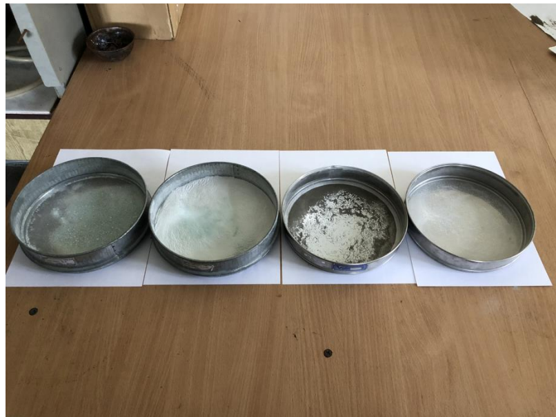
Рисунок 2.12. – Дослідження фракцій вогнегасного порошку
