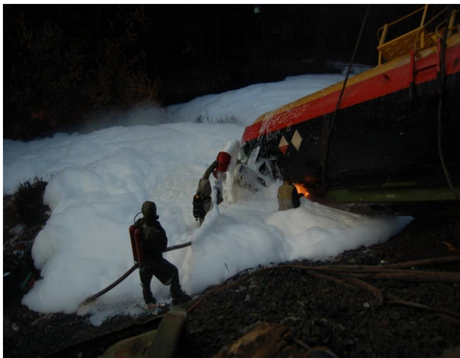
Рисунок 4.9 – Проведення електрозварювальних робіт ушкодженої залізничної цистерни з жовтим фосфором з використанням піни середньої кратності
