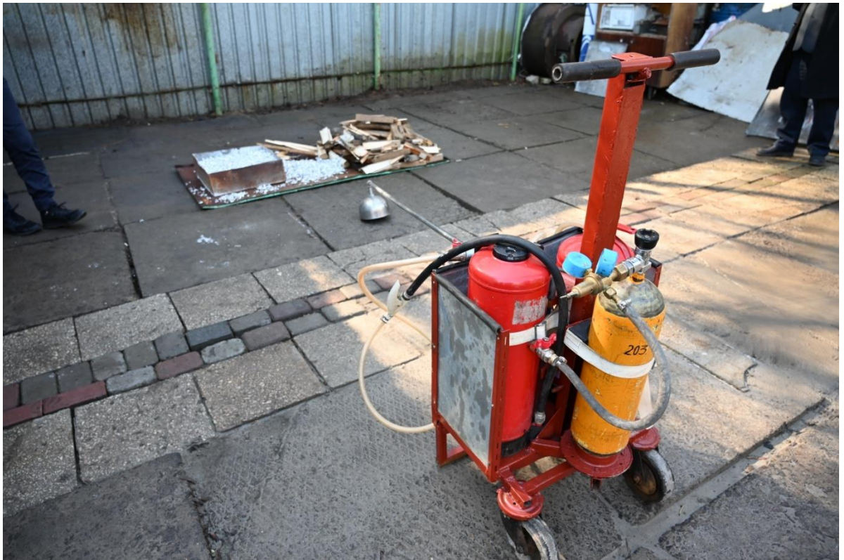
Рис. 4.7. Установка комбінованого гасіння перед проведенням полігонних випробувань
