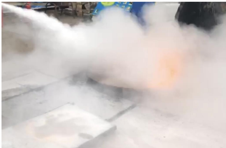
Рис. 2.4. Гасіння макетної пожежі класу В вогнегасним порошком КМ-3
