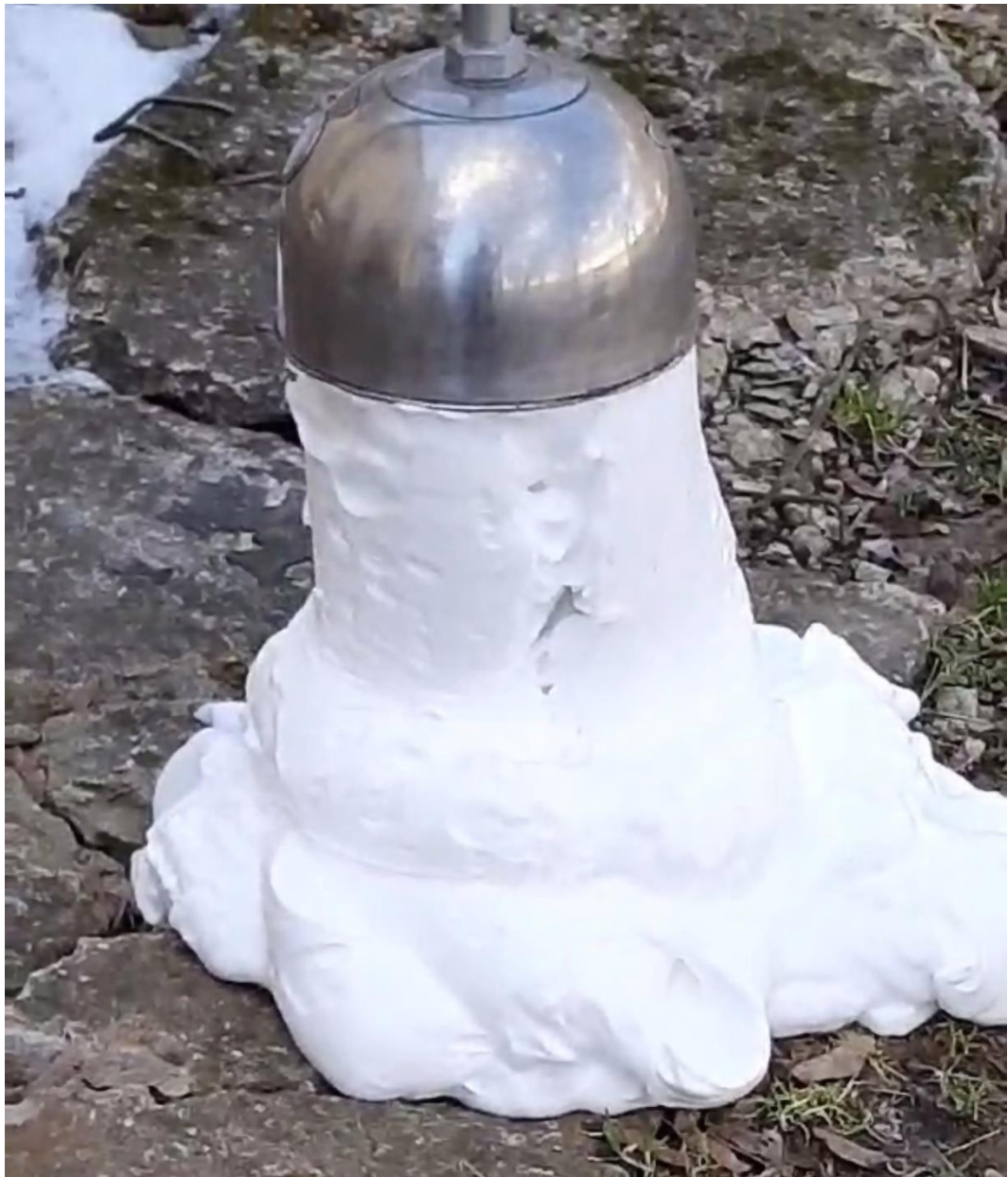
Рис. 4.2. Компресійна піна, яка утворилась з використанням насадки-заспокоювача та 6% розчину піноутворювача Барс S-2
