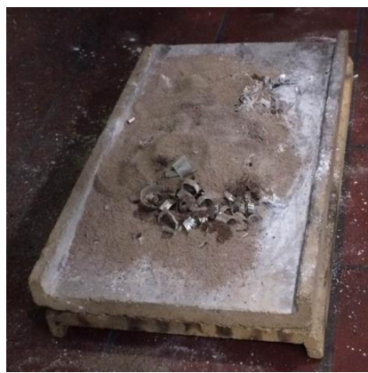
Рисунок 2.2 – Результати випробувань вогнегасних порошків для гасіння магнію
