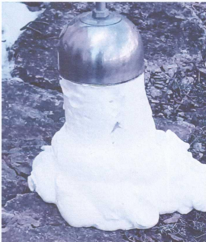
Рис. 5. Насадка заспокоювач для подачі порошків і компресійної піни.
