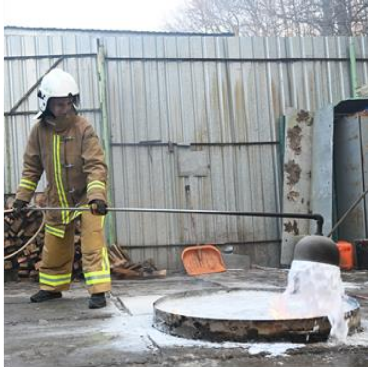
Рис. 3.12. Подавання піни за допомогою запропонованої насадки-заспокоювача
