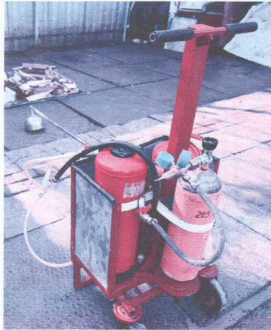
Рис. 2. Експериментальна установка порошково-пінного гасіння (УППГ) з використанням ВВП-12, ВП-12 та балоном із стиснутим повітрям
