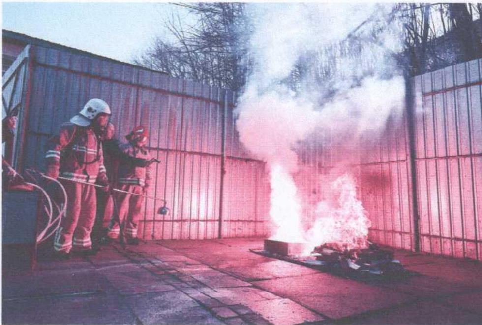
Рис. 3. Комбінована пожежа магнію і деревини з нафтопродуктом
