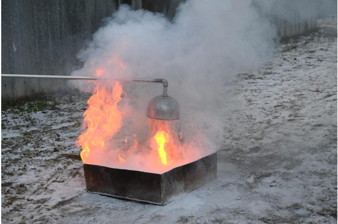
Рис. 4.3. Гасіння магнію порошком КМ-3 з використанням насадки-заспокоювача
