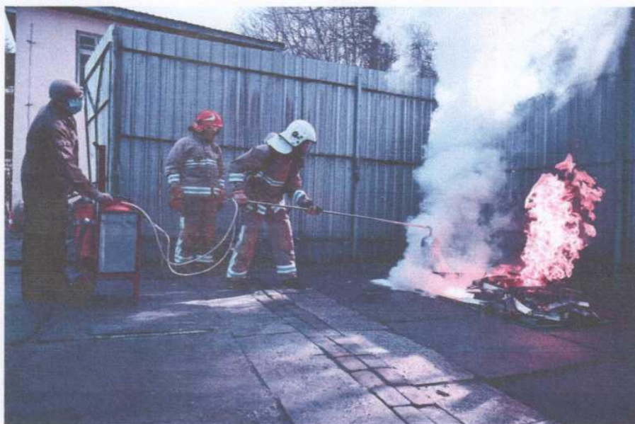
Рис. 4. Гасіння макетної пожежі магнію, нафтопродуктів та деревини комбінованим методом з використанням ВПСП та компресійної піни.
