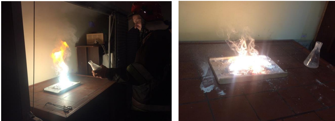
Рис. 2.1. Випробування вогнегасних порошків для гасіння сплавів магнію в лабораторних умовах
