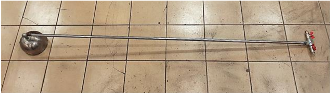
Рис. 3.11. Штанга із запропонованою насадкою-заспокоювачем: (труба, вентилі, заспокоювач)
