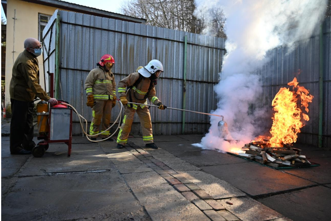
Рис. 4.6. Гасіння комбінованої пожежі деревини і магнію після подавання порошку піною підвищеної стійкості
