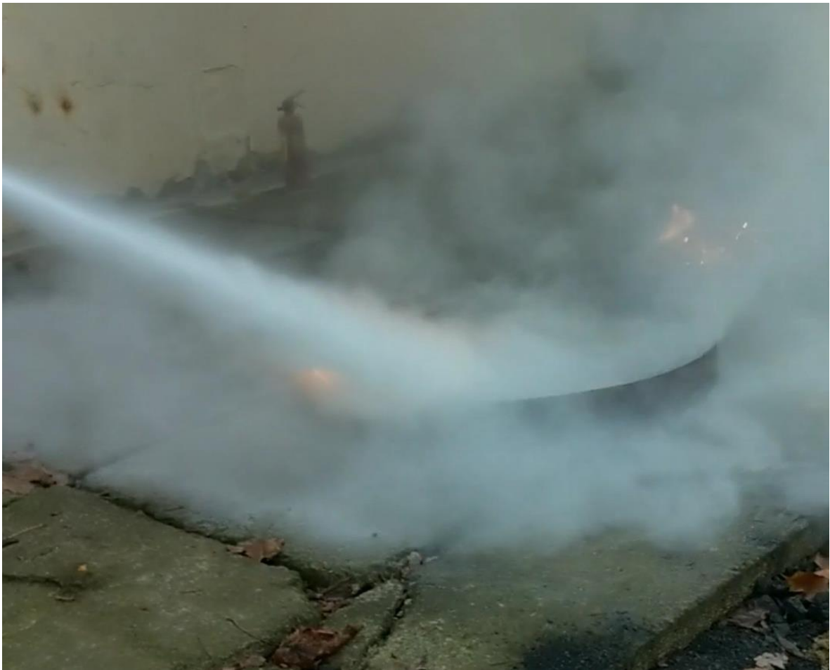
Рис. 4.4. Гасіння модельного вогнища 34В порошком КМ-3
