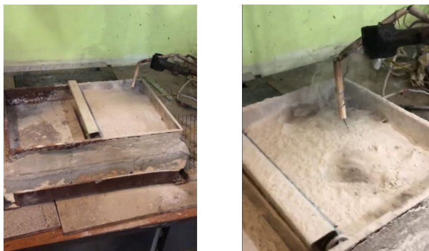
Рис. 2.8. Процес вимірювання температурних показників на поверхні шару вогнегасного порошку та на стику шару вогнегасного порошку та сплаву магнію під час процесу гасіння ошукорк сплаву магнію в лабораторних умовах
