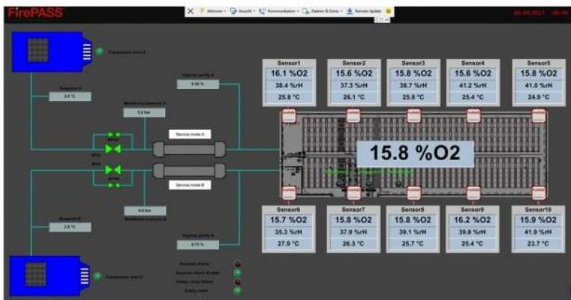
Рисунок 2 – Панель керування системою Fire PASS
