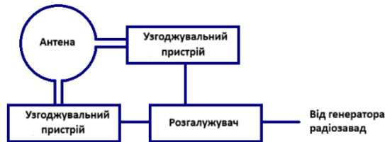
Рис. 1. Однокільцева антена та схема її підключення
