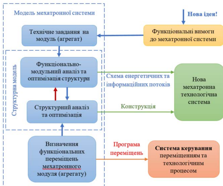
Рисунок 2 – Схема алгоритму проектування мехатронного модуля
