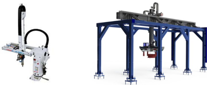
Рисунок 1 – Типові конструкції картезіанських технологічних машин
