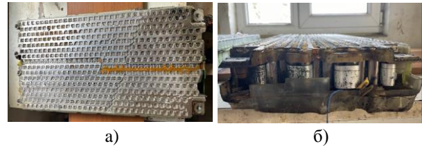
Рис. 2. Зовнішній вигляд модуля силової АКБ електромобіля Tesla Model S: а) вигляд згори; б) вигляд збоку
