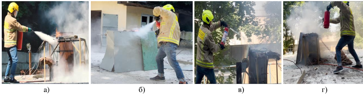
Рис. 6. Використання різних типів переносних вогнегасників під час гасіння літій-іонного модуля: а) ВП-5(з); б) ВВК-5; в) ВВП-5(з); г) ВВ-5(з)
