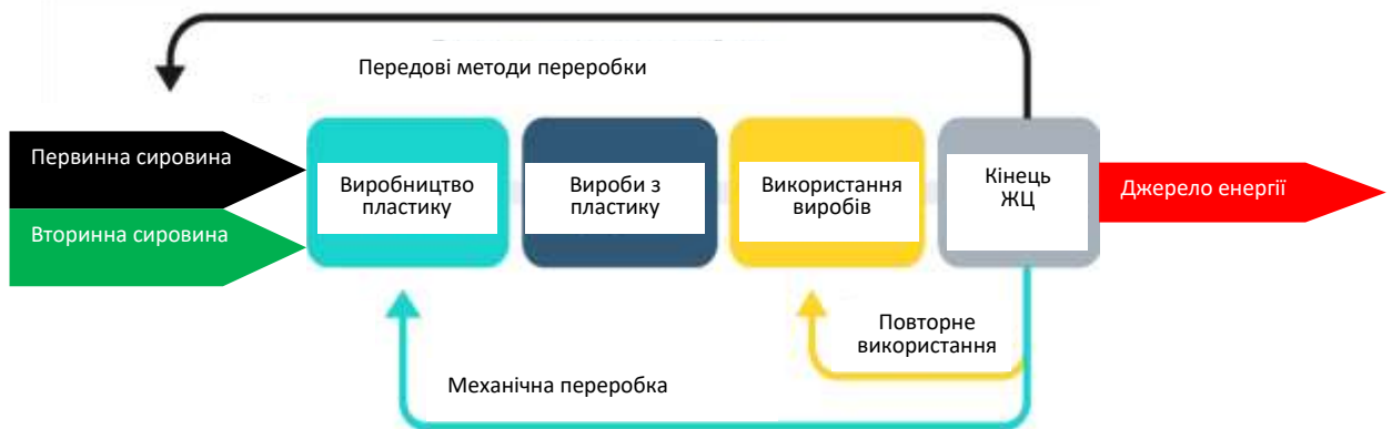
Рис. 1. Основний тренд в переробці відходів: перехід від лінійного до замкнутого циклу (за матеріалами компанії Dow Europe GmbH) [3].
