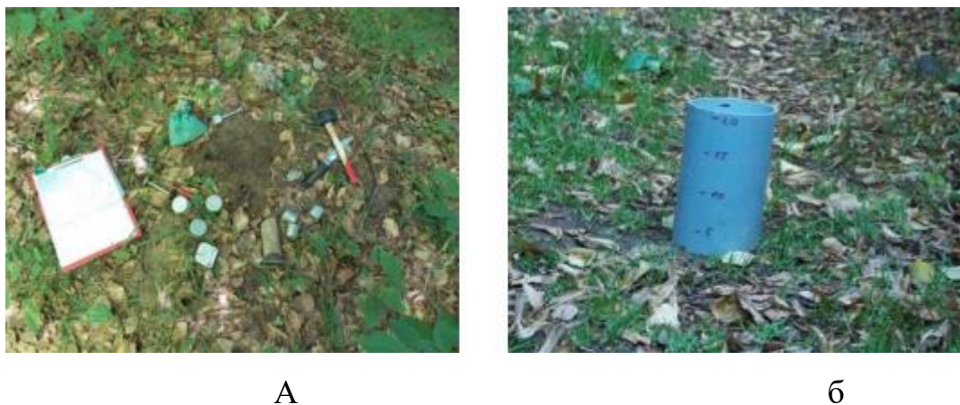
Рис. 2.4 Відбір зразків (верхнього шару 0-5 см ) ґрунту (а) та визначення водопроникності ґрунту в польових умовах (б)
