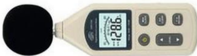
Рис. 4.2. Вимірювач рівня шуму, фільтр А/С, USB VENETECH GM1356 – цифровий шумомір для вимірювання шумів у діапазоні (30–130) дБ
