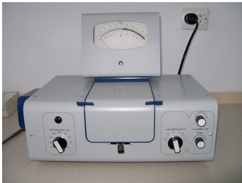
Рис. 3.1 Використовуваний лабораторний прилад для фотометрії – концентраційний електрофотоколориметр КФК-2
