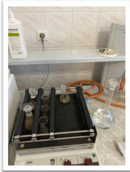
Рисунок 4.5 – Пробопідготовка. Перемішування на шейкері для утворення водної витяжки
