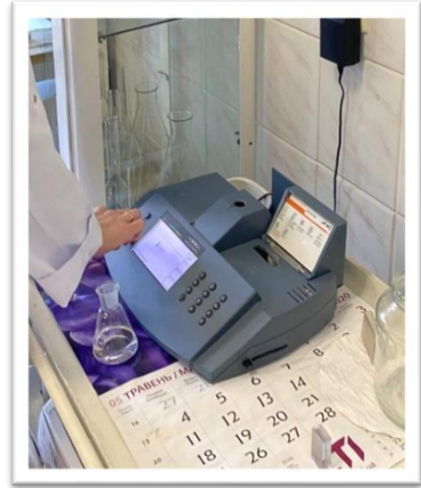
Рисунок 4.6 – Фотометрування підготовленої витяжки для визначення кількості нітратів
